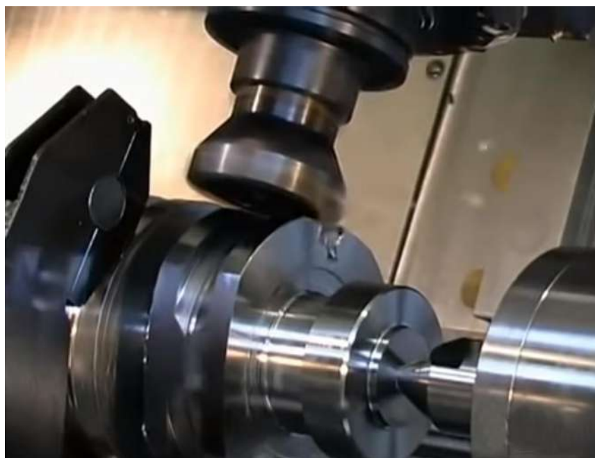
Рисунок 14.17 – Обробка настановних площадок на штоках і центрування колінчастих валів на фрезерно-центрувальному напівавтоматі
