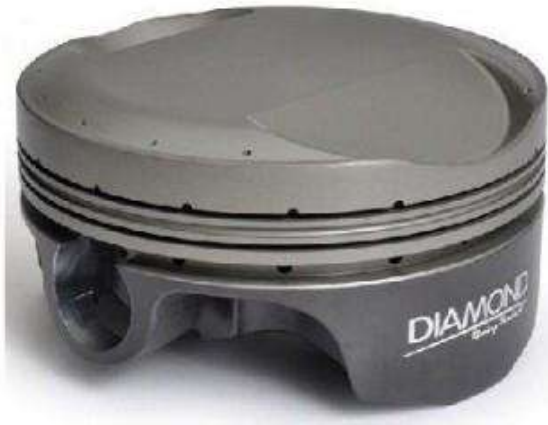
Рисунок 13.15 – Для кращого приробітку й запобігання задирам на юбку сучасного поршня наносять колоїдно-графітове покриття
