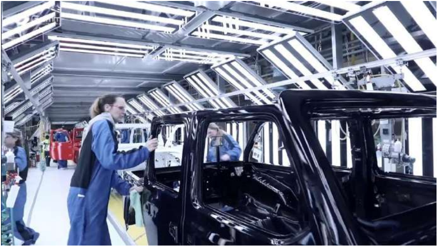
Рисунок 15.69 – Візуальний контроль якості покриття в безтіньовій камері (завод Jeep Wrangler, США)
