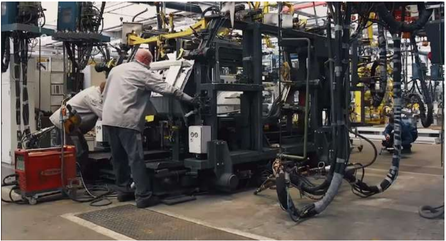
Рисунок 15.56 – Процес зварювання кузова автомобіля Mercedes G-Class в кондукторі (завод Magna Steyr Austria)
