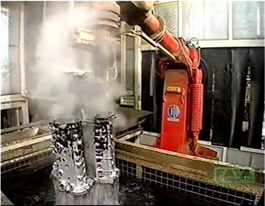
Рисунок 13.21 – Процес охолодження зануренням у воду отриманих алюмінієвих заготовок за допомогою механічного маніпулятора (FATA Aluminum, Italy)
