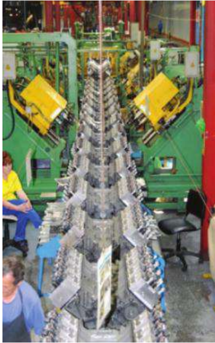
Рисунок 13.26 – Ділянка потокової лінії обробки блоків циліндрів
