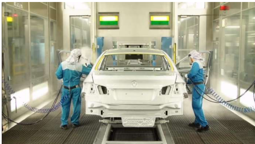
Рисунок 15.61 – Дофарбовування важкодоступних місць кузова автомобіля пневматичним розпиленням (завод BMW)
