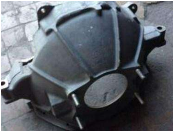
Рисунок 13.4 – Кожух зчеплення вантажного автомобіля є прикладом простої корпусної деталі
