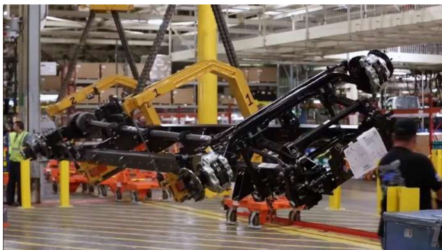
Рисунок 16.5 – Процес перевертання підібраної рами вантажівки Ford при переміщенні на наступне робоче місце під час складання
