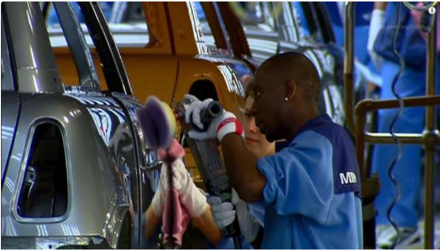
Рисунок 16.8 – Процес полірування кутовою шліфмашинкою окремих зон лакофарбового покриття кузова MINI R56 на заводі Mini в Англії (MINI Plant Oxford in the United Kingdom)
