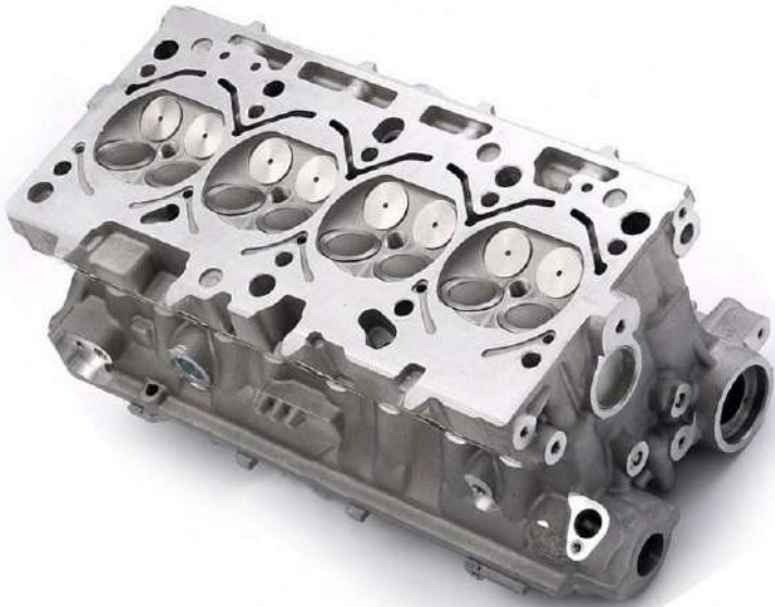
Рисунок 13.17 – Головка блоку циліндрів Audi A6 2.0 TFSI BPU зі шпильками та клапанами (а – загальний вид, б – вид знизу)
