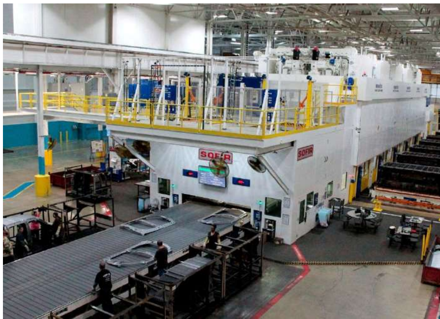
Рисунок 15.38 – Одна з автоматизованих пресових ліній нового «штампового заводу» (Sterling Heights Stamping Plant) компанії Stellantis North America у місті Стерлінг-Хайтс (шт. Мічіган); продуктивність всього заводу 75 000 деталей на добу (2 млн. на рік)
