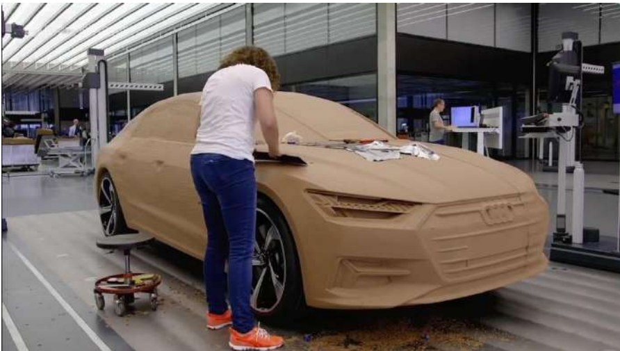
Рисунок 15.14 – Розробка макету зовнішньої поверхні кузова автомобіля Audi
