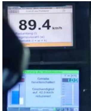
Рисунок 16.6 – Процес перевірки експлуатаційних характеристик сідельного тягача MAN на роликівому стенді
