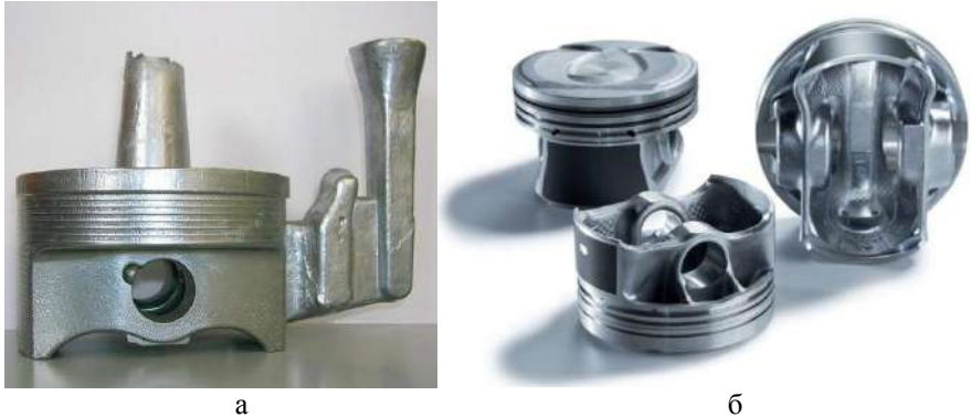
Рисунок 13.20 – Заготовка поршня (а) автомобільного двигуна і готові поршні (б) (FATA Aluminum, Italy)
