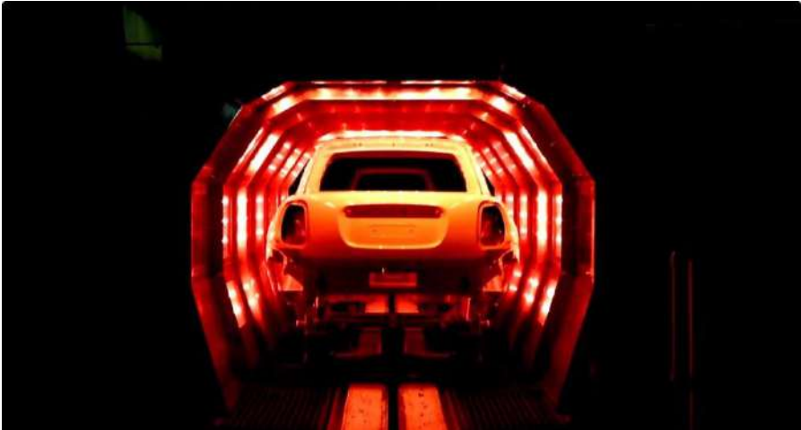
Рисунок 15.65 – Процес сушіння лакофарбового покриття кузова автомобіля Mini Cooper інфрачервоними променями (завод BMW в Cowley, Англія)
