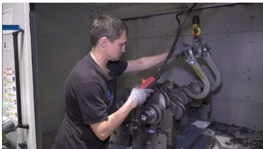
Рисунок 14.16 – Процес завантаження двох заготовок колінвалів на верстат з ЧПУ для подальшої одночасної обробки
