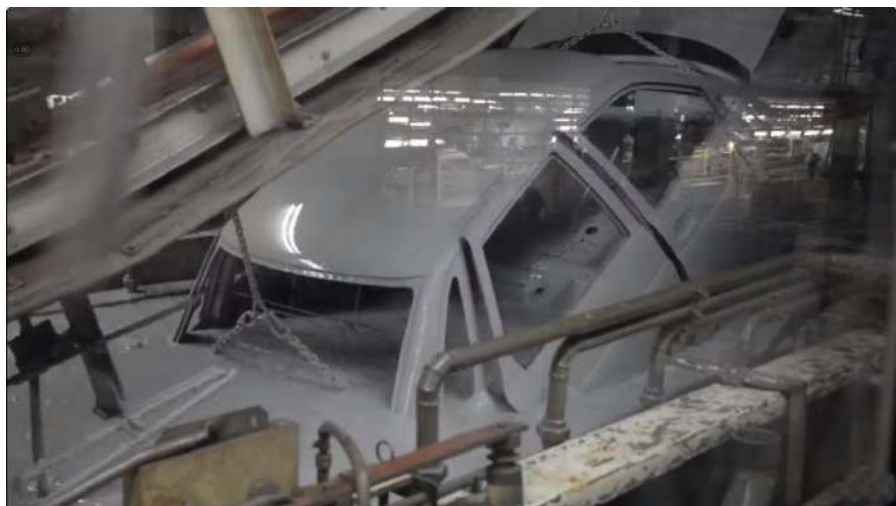
Рисунок 15.59 – Фарбування кузова зануренням за допомогою підвісного конвеєру
