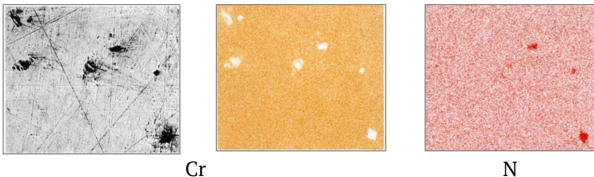
Рис. 1.14. Сульфіди титану в сплаві 06ХН28МДТ ( \times 1200 ).
