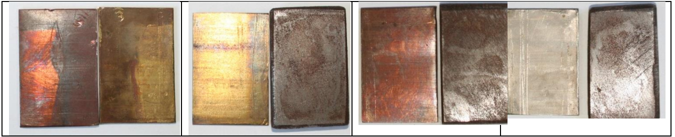
Рис. 6.7. Вигляд поверхні зразків після після випробувань на щілинну корозію у 3% розчині NaCl (відсутні сліди локальної корозії).
