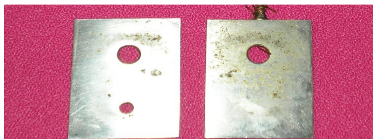
Рис. 4.1. Зразок зі струмовідводом і контртіло для електрохімічних досліджень сталі в хлоридовмісному розчині 3% NaCl [343].
