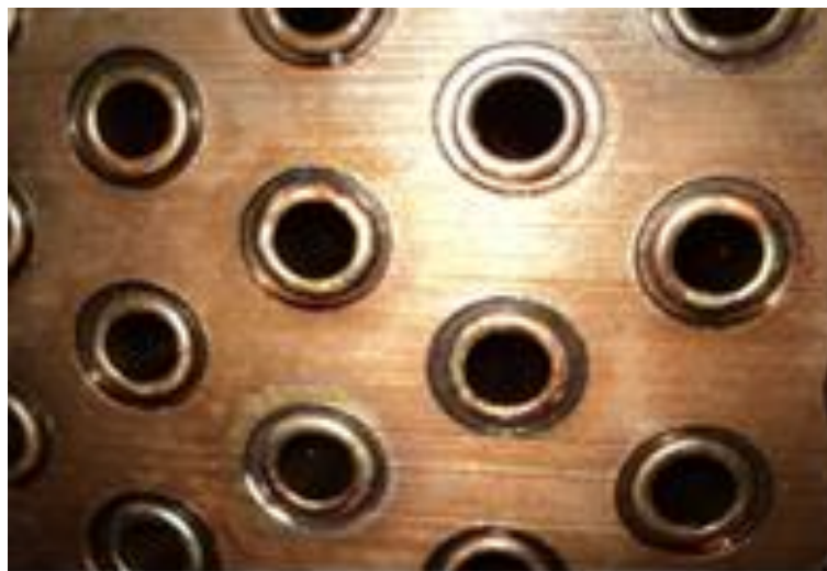
Рис. 6.9. Обварені електродуговим зварюванням кінці теплопередавальних трубок з плакованою міддю трубною решіткою.
