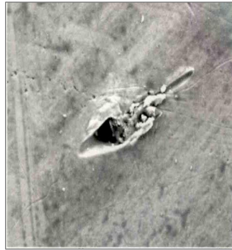
Рис. 1.9. Щілина між включеннями і аустенітною матрицею на поверхні сталі AISI 321: а – оксид алюмінію ( \times 2500 ); б – нітрид титану ( \times 900 ).
