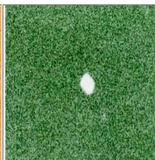
Рис. 1.3. Титанованадієвий нітрид в сталі AISI 304 ( \times 500 ).
