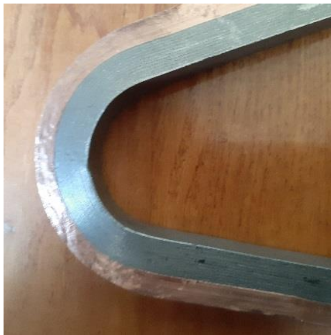
Рис. 6.13. Згин зразка через призму, R = 3 мм на кут 150^\circ .
