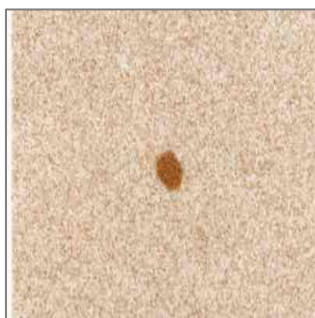
Рис. 1.3. Титанованадієвий нітрид в сталі AISI 304 ( \times 500 ).
