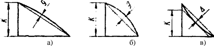
Рисунок 2.5 - Визначення катета шва
