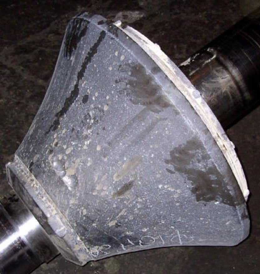
Рисунок 2.10 – Зовнішній вид зношеного рухомого конуса
