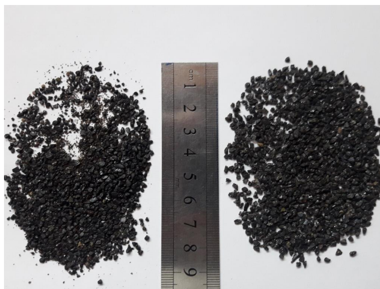
Рисунок 2.4 – Електрокорунд нормальний 14А ГОСТ 28818 – 90 шліфзерно FEPА F12 ГОСТ 3647 – 80
