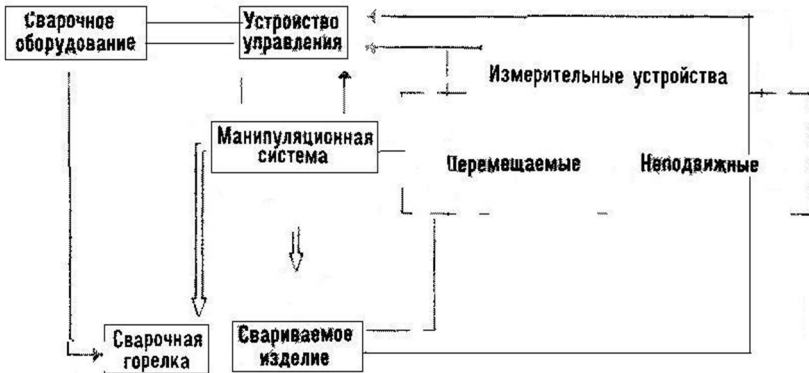
Рисунок 2.1 – Склад робототехнологічного комплексу для зварювання
