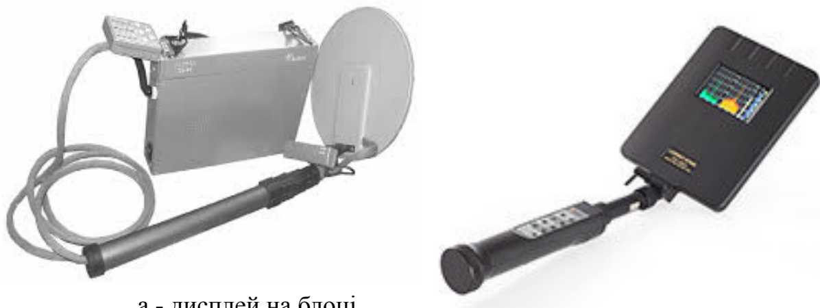
а - дисплей на блоці приймача; б - дисплей на корпусі антени
