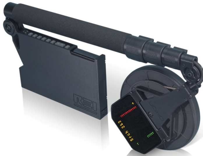
Рисунок 2.10- Нелінійний локатор "ORION HGO-4000 High Gain"
