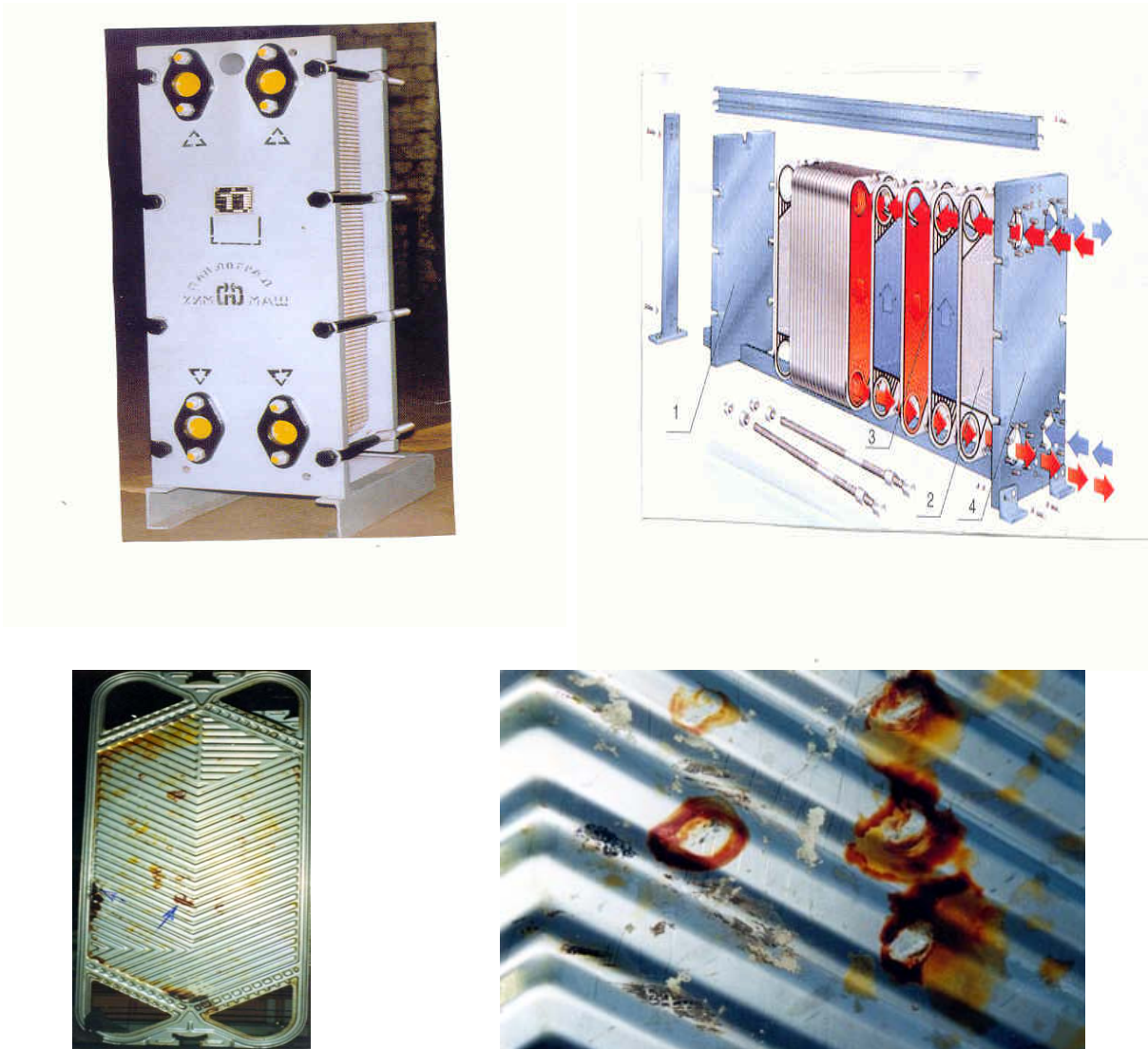
Рис. 1.1. Пітінгова корозія пластин теплообмінника зі сталі AISI316Ti в оборотній воді
