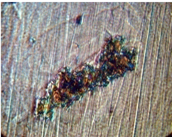
Рис. 3.5. Включення в сталі AISI 321: а – дрібні включення \delta -фериту; б – \delta -ферит в околі карбонітридів титану ( \times 500 ) [5].
