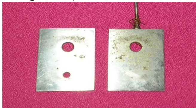
Рис. 4.1. Зразок зі струмовідводом і контртіло для електрохімічних досліджень сталі в хлоридовмісному розчині 3%NaCl
