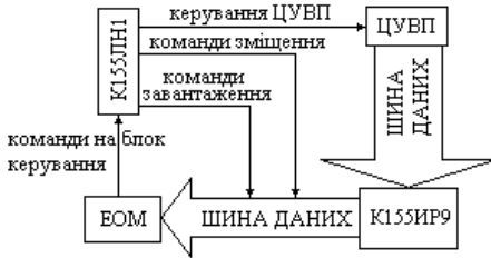
Рисунок 5.4 – Схема автоматизованого вимірювального комплексу "РЕЛАКСАЦІЯ"
