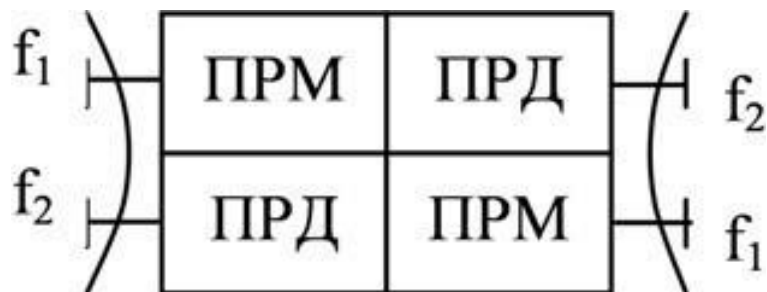
Рисунок 1.3– Структурна схема дуплексної ПРС
