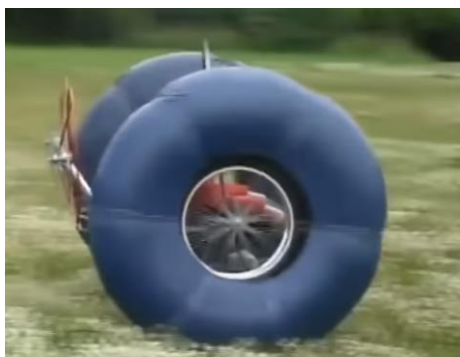
Рисунок Б.4 – Транспортний засіб «Кенгуру» з аеропневматичною підвіскою [59]: a – загальний вид; б – рух на воді
