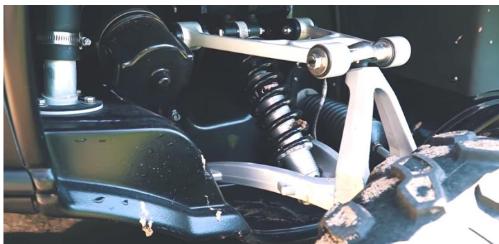
Рисунок В.1 – Легковий автомобіль-амфібія Watercar [62]: a – вхід у воду; б – рух в режимі глісерування; в – рух в режимі малого ходу; з – водометний рушій; д – підвіска-система складання коліс для руху на воді
