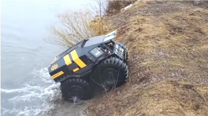
Рисунок Б.1 – Всюдихід-амфібія Sherp на шинах наднизького тиску [55, 56]: а – рух на воді; б – вихід з води
