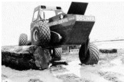
Рисунок 2.6 – Колісно-крокуючий рушій: a – схема; б – колісно-крокуючий всюдихід «Go-Devil»
