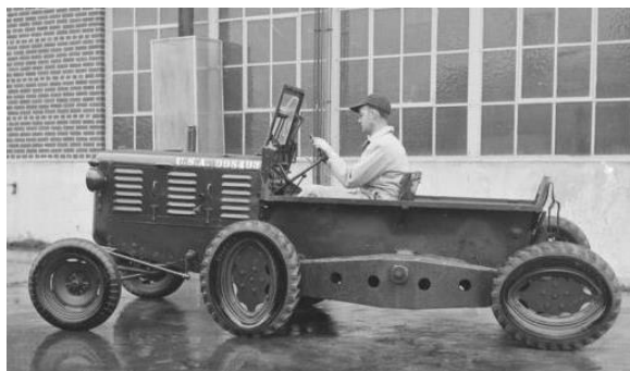
Рисунок 1.8 – Еліптичні колеса Копчинського: а – крокуючі колеса в дії; б – трактор М7 з еліпсоїдними колесами
