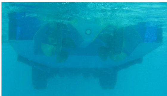
Рисунок В.2 – Автобус-амфібія LX-484-AL Hippotrip Mar [63]: a – загальний вид; б – гребні гвинти; в – положення рушія в воді
