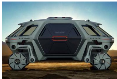
Рисунок 1.6 – Загальний вид концептуального мобільного транспортного засобу Elevate: a – вид збоку, елементи рушія у звичайному положенні; б – вид спереду, елементи рушія у розгорнутому положенні
