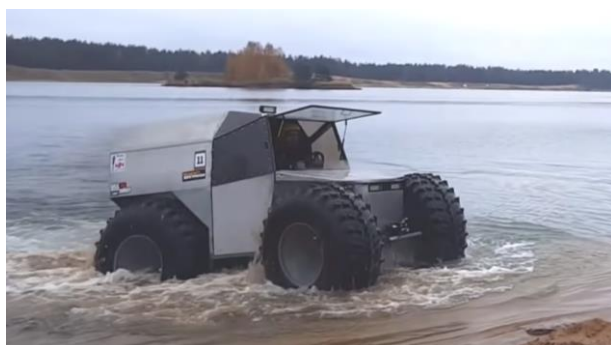
Рисунок Б.3 – Всюдихід-амфібія «Трофі» [58]: a – вхід у воду; б – рух на воді; в – вихід з води
