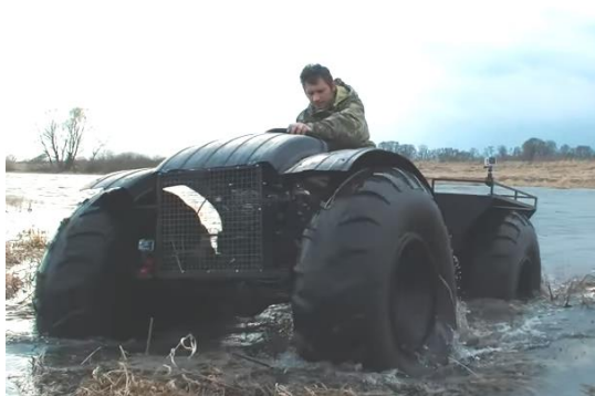
Рисунок Б.2 – Всюдихід на великих колесах (спеціальний рушій) зі зчленованою рамою та шинами низького тиску [57]:
