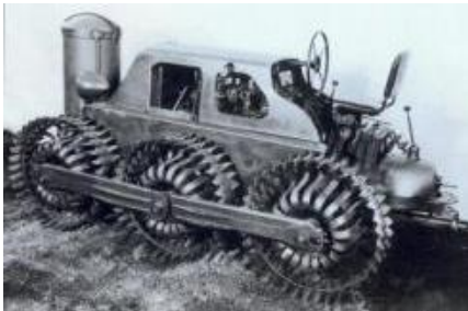
Рисунок 1.10 – Елементи рушія Ернста Мейлі: a – бронемашина, прийнята на озброєння швейцарських сил самооборони; б – всюдихід; в – сталеве колесо
