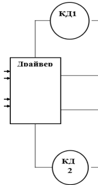
Рисунок 5.1 – Структурна схема електричного приводу, КД1, КД2 – крокові двигуни
