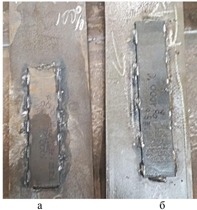
а – гартування + ізотермічна витримка; б – гартування. Рисунок 5 – Відремонтовані броні.
