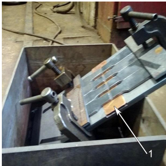
Рисунок 13 – Стандартизовані зразки, які зібрано під зварювання. Мідну підкладку 1 під час зварювання видалено.
