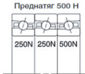
Рисунок 1.10 – Внутрішній преднатяг компоновки ТВТ.
