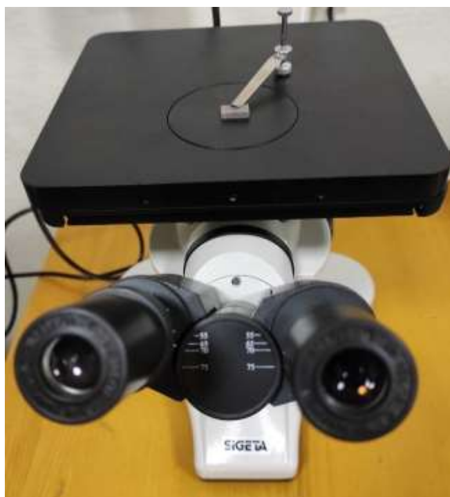
Рисунок 2.2 - Оптичний мікроскоп Sigeta MM 700.
