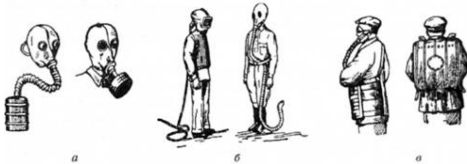
а – фільтрувальні; б – шлангові; в – ізолювальні
