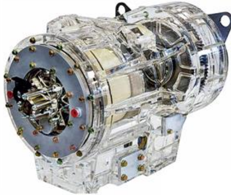
Рисунок 6.6 – Виставковий зразок маховика Torqstor з частково прозорим картером
