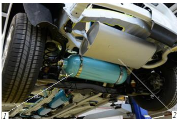
Рисунок 5.1– Вид днища автомобіля: 1 – металевий резервуар; 2 – глушник
