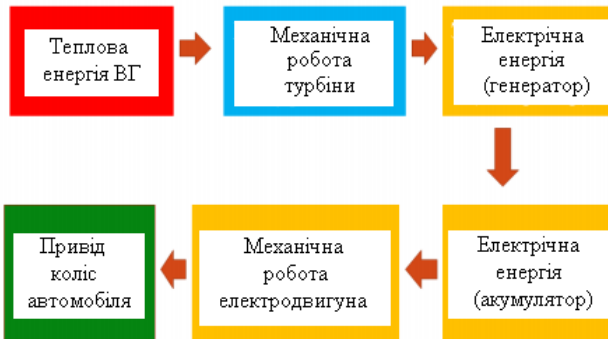
Рисунок 3.2 – Схема перетворення енергії відпрацьованих газів у прототипі Honda
