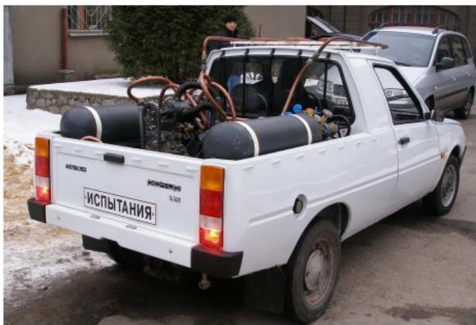
Рисунок 5.2 – Автомобіль «Таврія», обладнаний створеною в ХНАДУ експериментальною гібридною силовою установкою схеми «ДВЗ на стиснутому природному газі – поршневий пневмодвигун»
