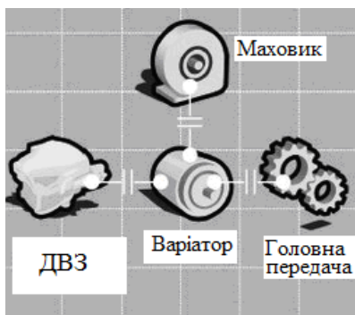
Рисунок 6.9 – Елементи конструкції маховикових машин: а – машини на паливних елементах; б – машини з ДВЗ
