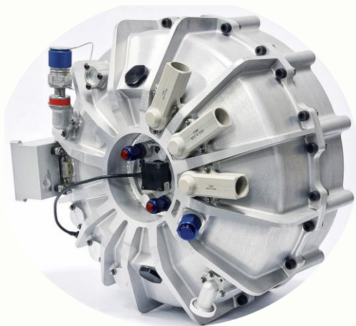
Рисунок 6.7 – Маховик від Williams Hybrid Power (такі агрегати випробовувалися на автобусах Лондона як допоміжний привід)
