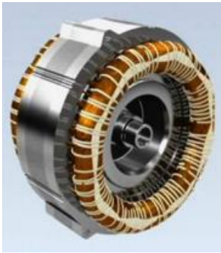
Рисунок 2.33 – Мотор-генератори різних моделей: а – МГ1 моделі МНВ20; б – МГ1 моделі ZVW30; в – МГ2 моделі МНВ20; г – МГ2 моделі ZVW30
