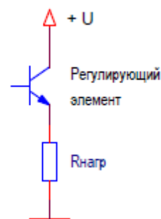
Рисунок 2.5 – Використання транзистора у якості регулюючого елемента
