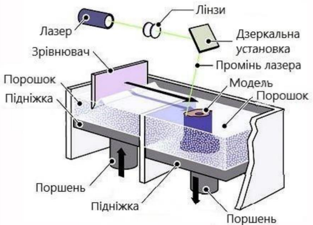
Рисунок 1.3 – Схема установки для SLM
