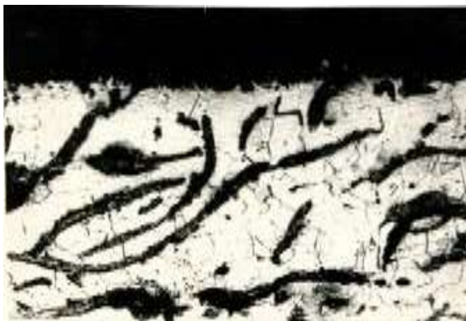
Рисунок 3.1 – Мікроструктура сірого чавуну після дифузійного титанування в суміші з 13% NaCl [113]
