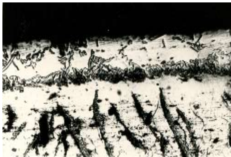
Рисунок 3.3 – Мікроструктура сірого чавуну після дифузійного титанування в суміші з 7% NH 4 Cl [113]
