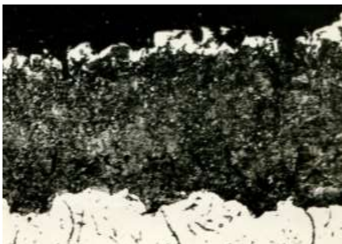
Рисунок 4.2 – Мікроструктура чавуну після дифузійного хромування в суміші з 4% \text{NH}_4\text{F} [119]
