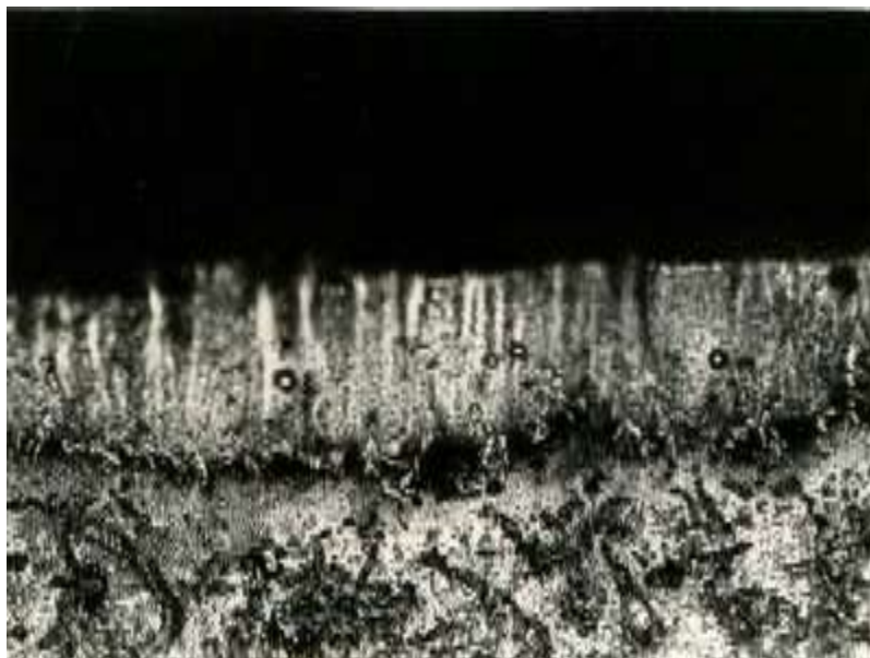
Рисунок 3.5 – Мікроструктура сірого чавуну після дифузійного титанування в суміші з 13% \text{NH}_4\text{Cl} [113]
