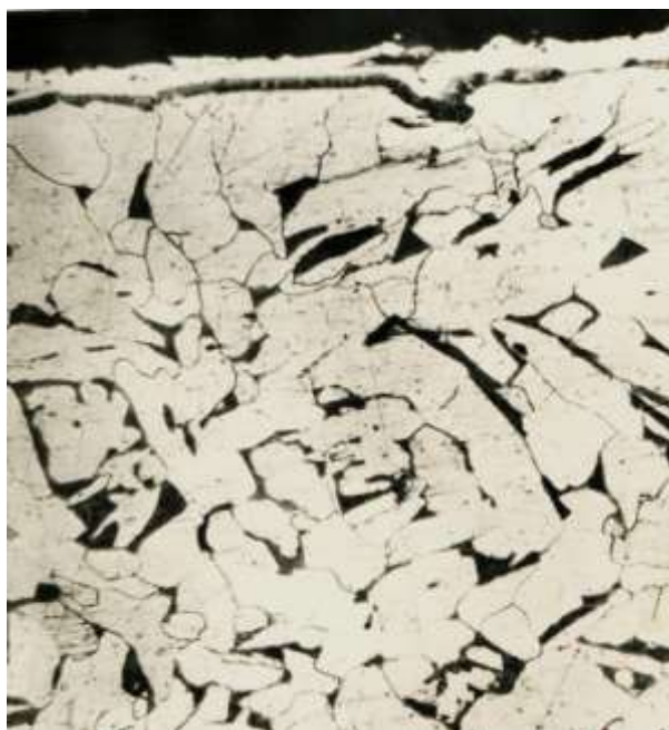
Рисунок 4.21 – Мікроструктура хромованої сталі, суміш №6
