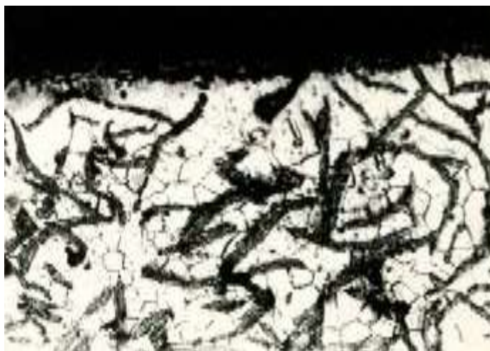
Рисунок 3.2 – Мікроструктура сірого чавуну після дифузійного титанування в суміші з 13% NaF [113]
