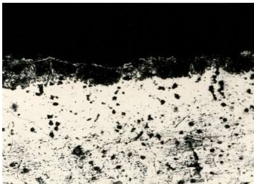
Рисунок 3.6 – Мікроструктура сірого чавуну після дифузійного титанування в суміші з 13% \text{NH}_4\text{F} [113]
