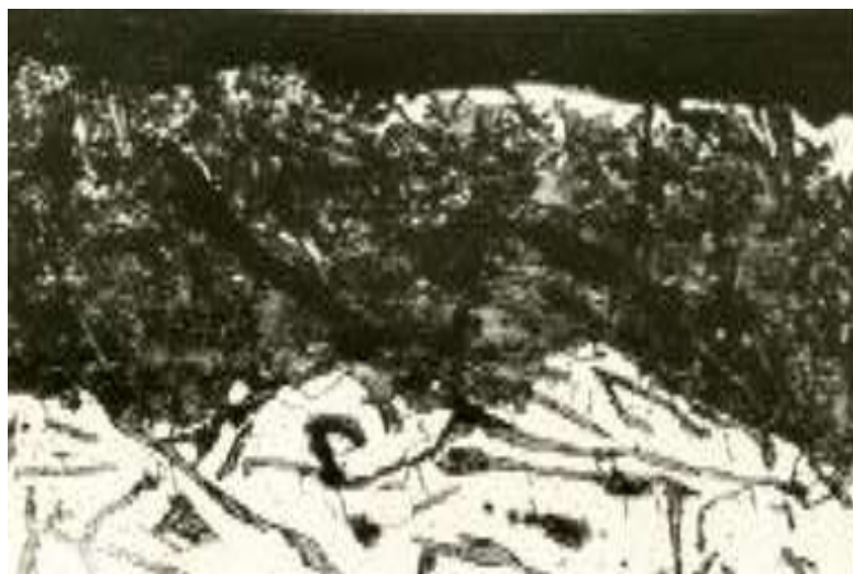
Рисунок 4.3 – Мікроструктура чавуну після дифузійного хромування в суміші з 4% NaCl [119]
