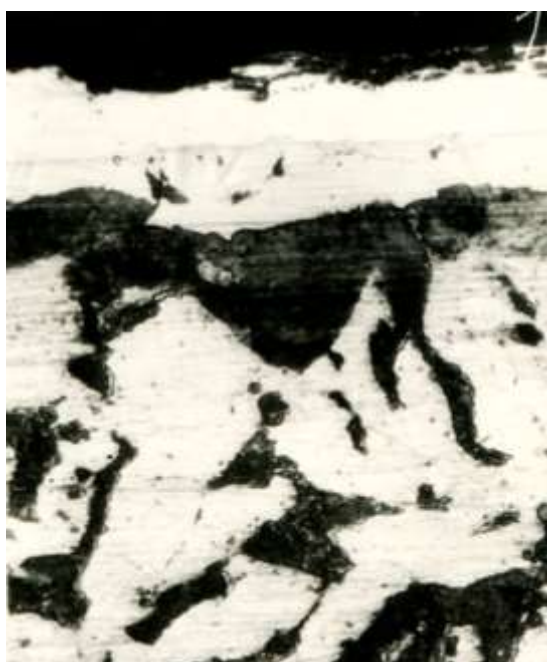
Рисунок 4.22 – Мікроструктура хромованого сірого чавуну, суміш №6
