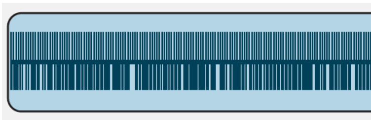
Рисунок 4.3- Схематичне уявлення шкали з додатковою інкрементною доріжкою
