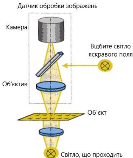
Рисунок 7.3 - Базова конструкція датчика обробки зображень з джерелами відбитого світла і того що проходить
