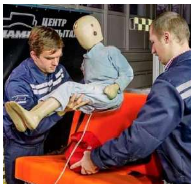
Рисунок 7.13 – Установка дитячого манекена на сидіння
