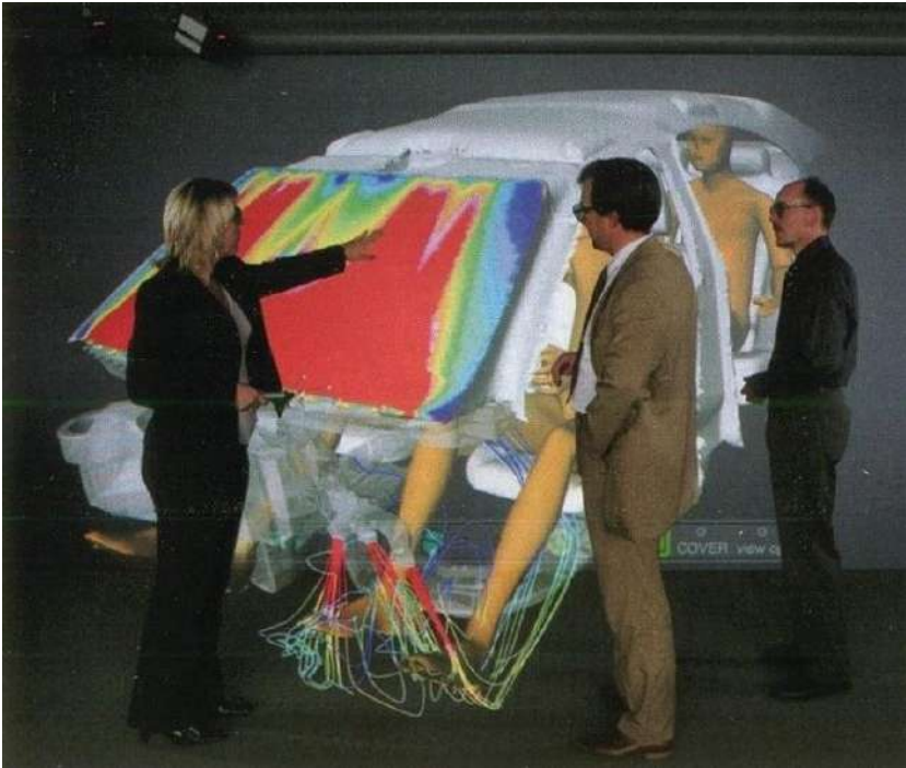
Рисунок 14.8 – Аналіз напрямку повітряних потоків та їх температури за допомогою технологій VR
