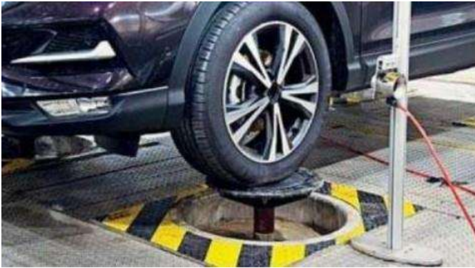
Рисунок 9.15 – Стенд для випробування підвіски автомобіля
