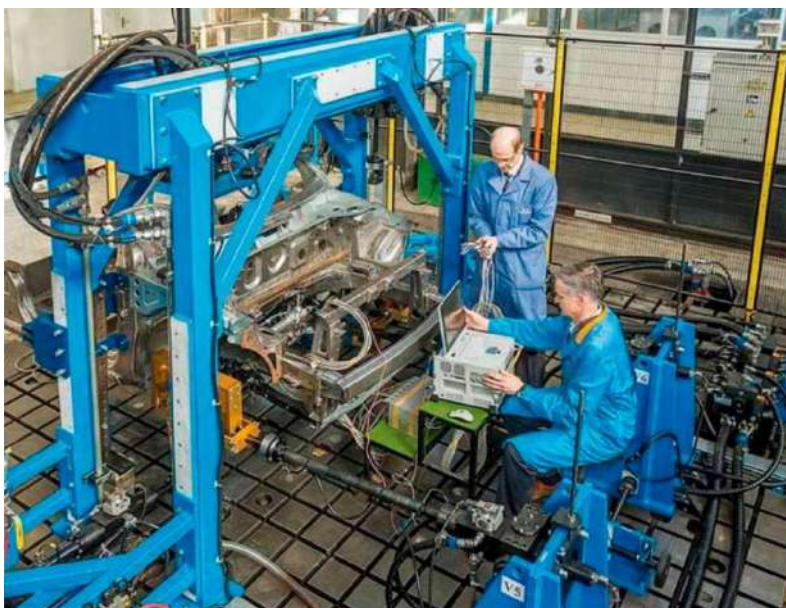
Рисунок 9.10 – Процес випробування окремих деталей автомобільного кузова
