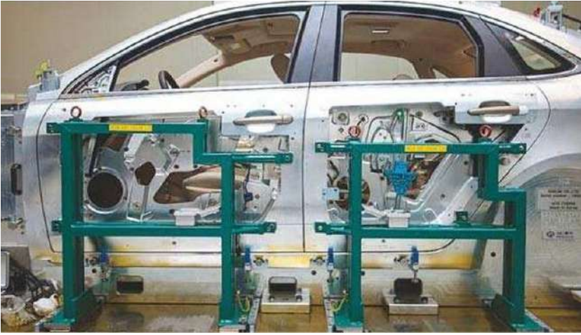
Рисунок 9.12 – Додаткова перевірка зазорів кузова
