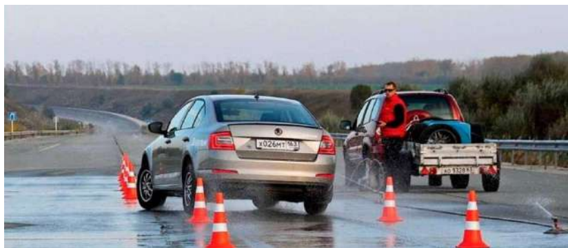
Рисунок 9.24 – Випробування автомобіля на керованість на мокрому асфальті (поперечне аквапланування)
