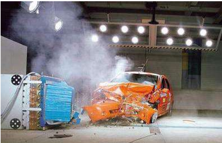
Рисунок 9.14 – Процес випробування автомобіля на фронтальний удар
