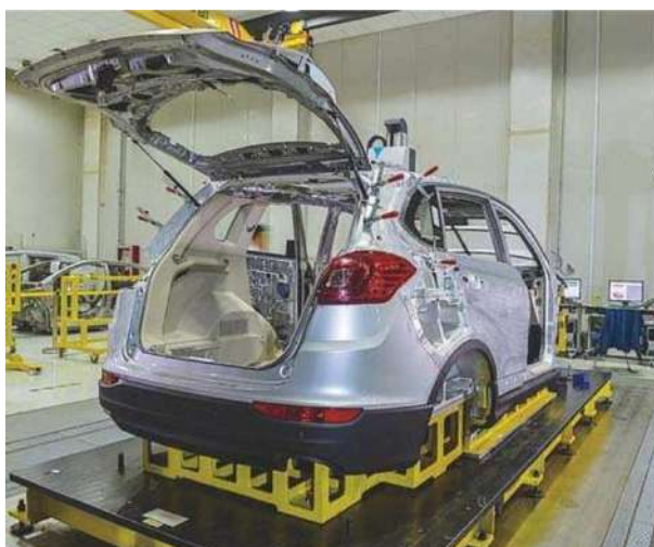
Рисунок 9.11 – Перевірка геометрії кузова на вимірювальному стенді
