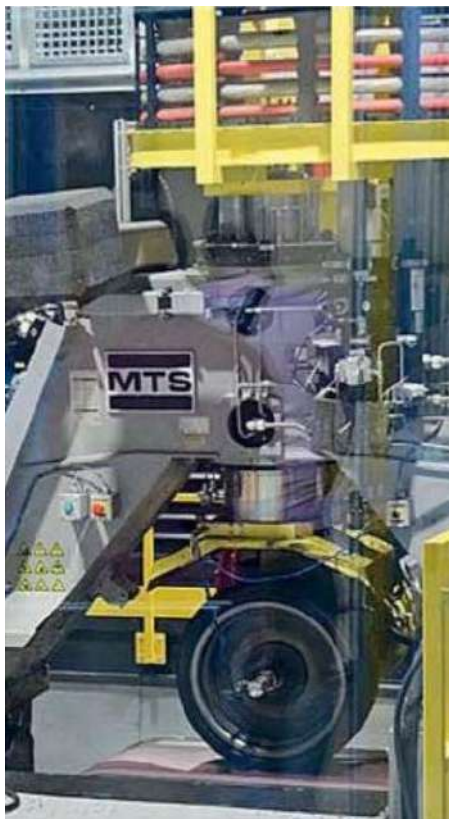
Рисунок 9.17 – Стенд для випробування шин компанії Pirelli
