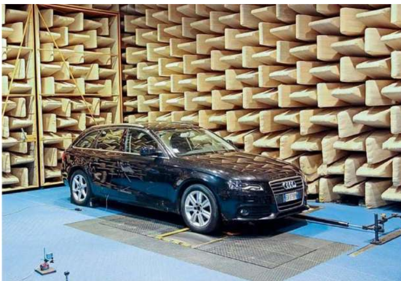
Рисунок 9.16 – Безехова камера для визначення рівню шуму від шин
