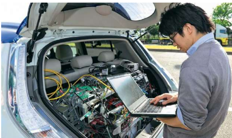
Рисунок 9.21 – Розміщення в багажнику Nissan апаратури для проведення ходових випробувань
