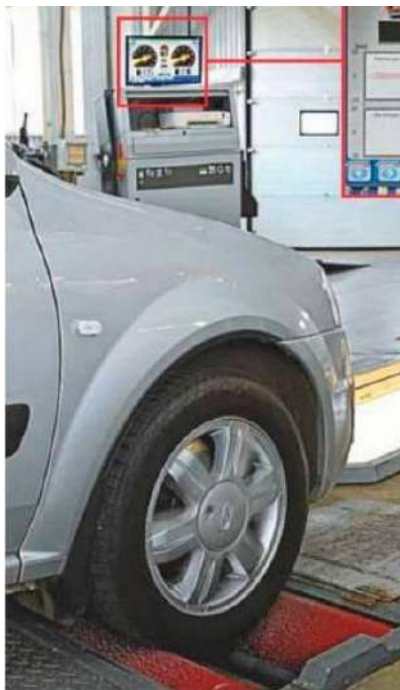
Рисунок 9.20 – Автомобіль встановлений на роликівому гальмівному стенді
