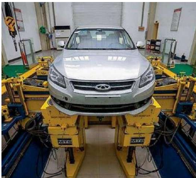
Рисунок 9.9 – Процес випробування жорсткості автомобільного кузова
