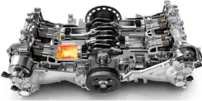
Рисунок 2.3 – Розріз горизонтально-опозитного двигуна Subaru
