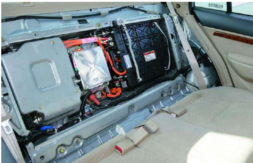
Рисунок 11.5 – Розміщення батареї за спинкою сидіння у Honda Civic Hybrid
