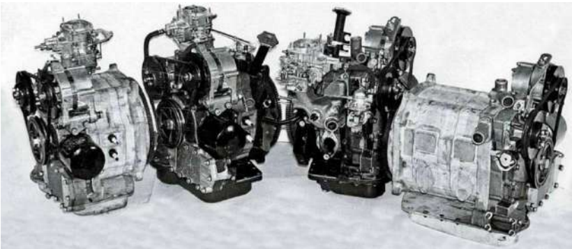
Рисунок 9.5 – Сімейство роторних двигунів ВАЗ-311 і -411 розроблених у 1970-ті роки у СРСР на заводі ВАЗ
