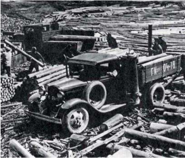
Рисунок 8.5 – Газогенераторний ГАЗ-42 на лісозаготівлях у Сибіру
