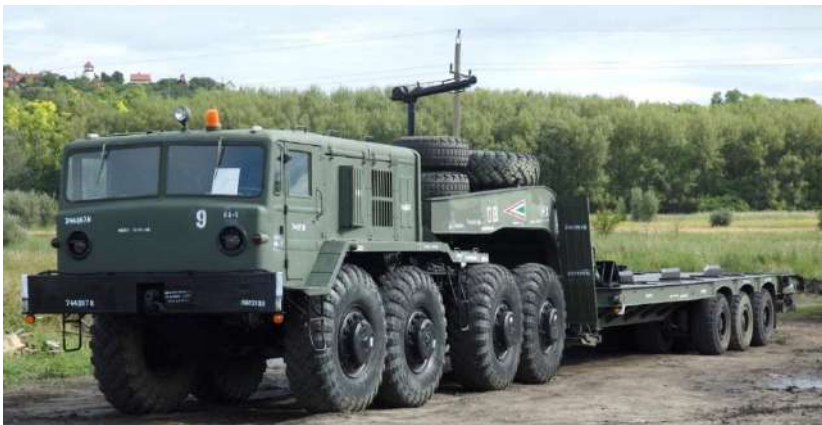
Рисунок 2.9 – МАЗ 570 із двигуном розташованим за кабіною
