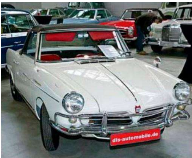
Рисунок 9.2 – NSU Wankel Spider (осінь 1963 р.): односекційний двигун 0,5 л, розвивав 50 к.с. при 6000 об/хв і 152 км/год
