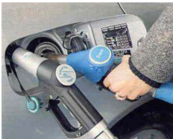
Рисунок 8.3 – Газозаправний штуцер поруч із заливною горловиною паливного бака
