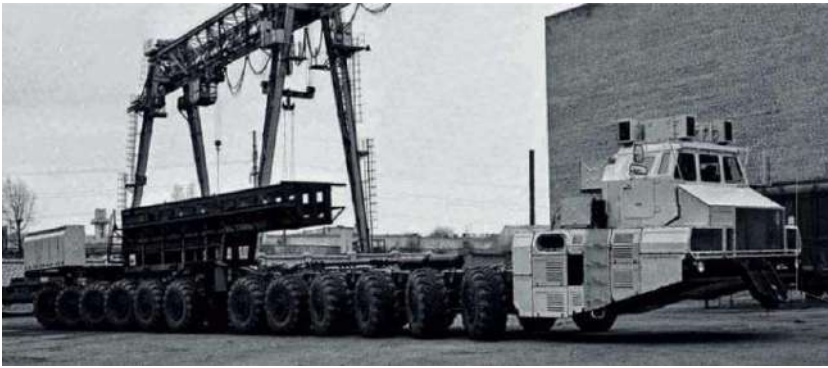
Рисунок 10.3 – Останній радянський автомобіль з турбіною (1250 к.с.) і електричною трансмісією МАЗ-7907 (1985 р.)
