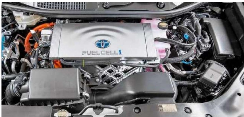
Рисунок 13.11 – Моторний відсік Toyota Mirai: Fuel cell – це блок управління паливними елементами, а також зарядкою акумуляторної батареї
