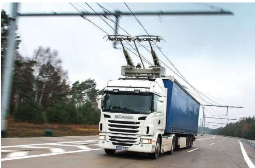
Рисунок 14.4 – Електровантажівка Scania під час руху по «e-highway» на сході центральної Швеції
