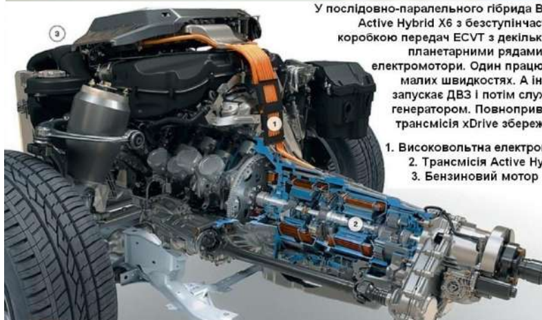
Рисунок 11.8 – Послідовно-паралельна схема гібрида BMW Active Hybrid X6
