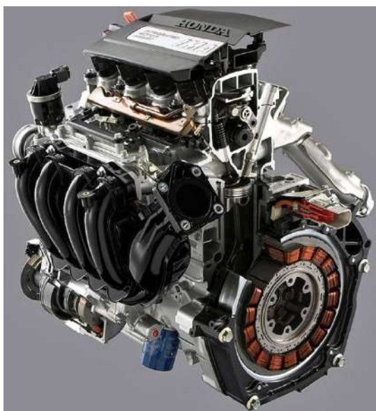
Рисунок 11.6 – Двигун Honda Civic Hybrid із системою Integrated Motor Assist, IMA (інтегрований помічник двигуна)
