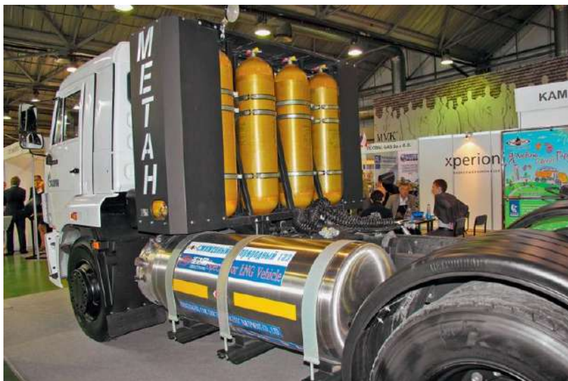
Рисунок 8.2 – Розміщення газових балонів на дизельному КамАЗі
