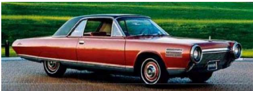
Рисунок 10.2 – Chrysler Turbine це єдиний у світі газотурбінний легковий автомобіль, який був випущений невеликою серією.
