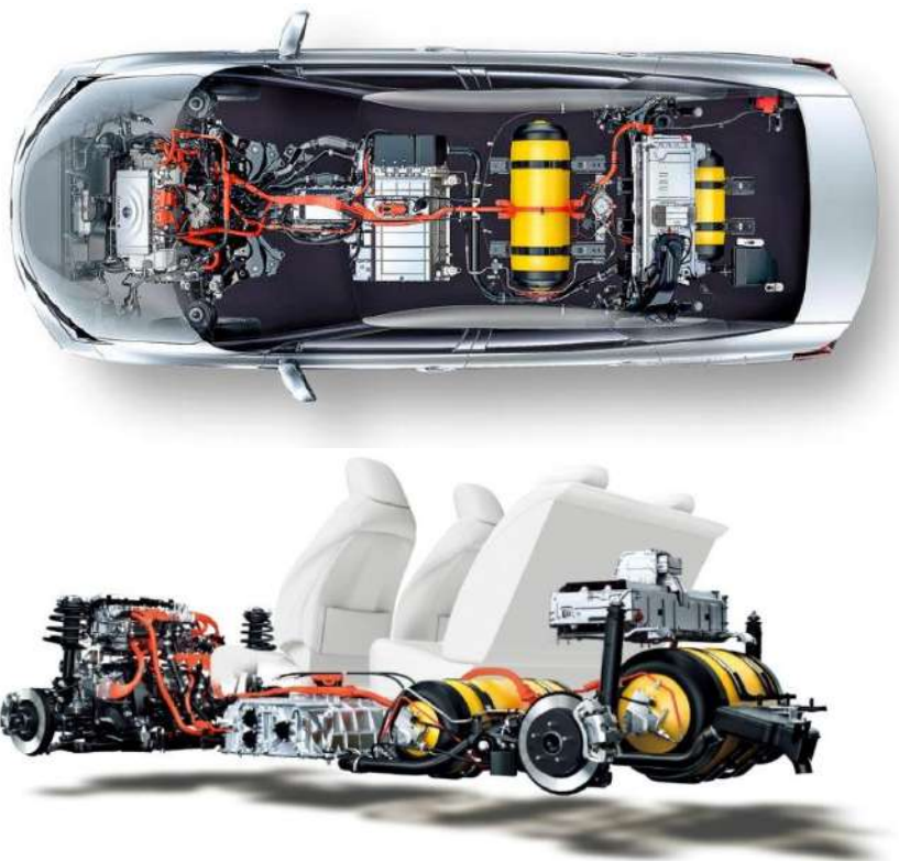
Рисунок 13.10 – Силова установка Toyota Mirai: попереду розташований електродвигун, водневі баки жовтого кольору на 60 і 62,4 л, додаткова батарея поза спинкою сидіння, блок паливних водневих елементів розміщений у середині автомобіля
