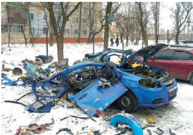
Рисунок 8.12 – Наслідки розриву композитного метанового балону
