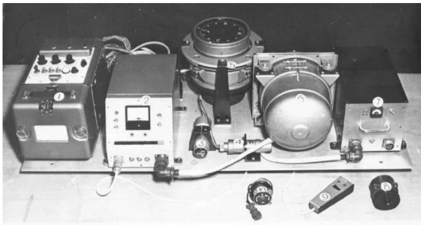
Рисунок 10.26 – Розроблений та виготовлений на кафедрі Автомобілі бортовий вимірювальний комплекс для проведення випробувань автомобілів в дорожніх умовах
