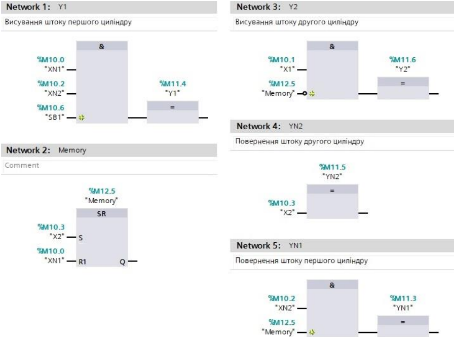
Рисунок 4.3 – Програма керування рухом двох циліндрів варіанту В
