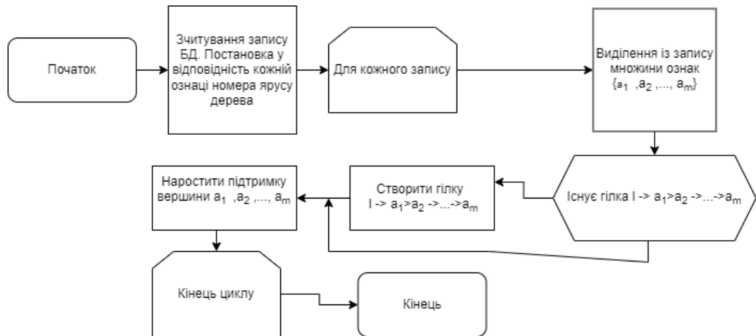
Рисунок 2.1 – Блок-схема модифікованого алгоритму побудови дерева покриття
