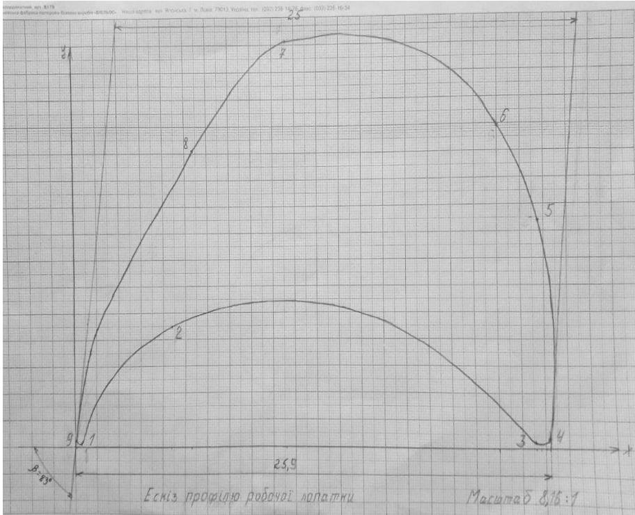
Рисунок Г.5 - Ескіз профілю робочої лопатки (в масштабі)
