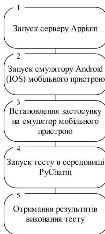
Рисунок 4.1 – Алгоритм роботи автоматизованих функціональних тестів на емуляторі
