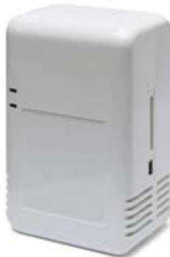
Рисунок 2.1 – Мініатюрний комп'ютер SheevaPlug
