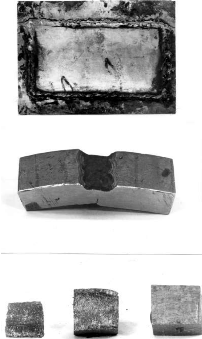
Рисунок 5.8 – Зовнішній вигляд і мікроструктури зразків після експлуатації та практичних випробувань
