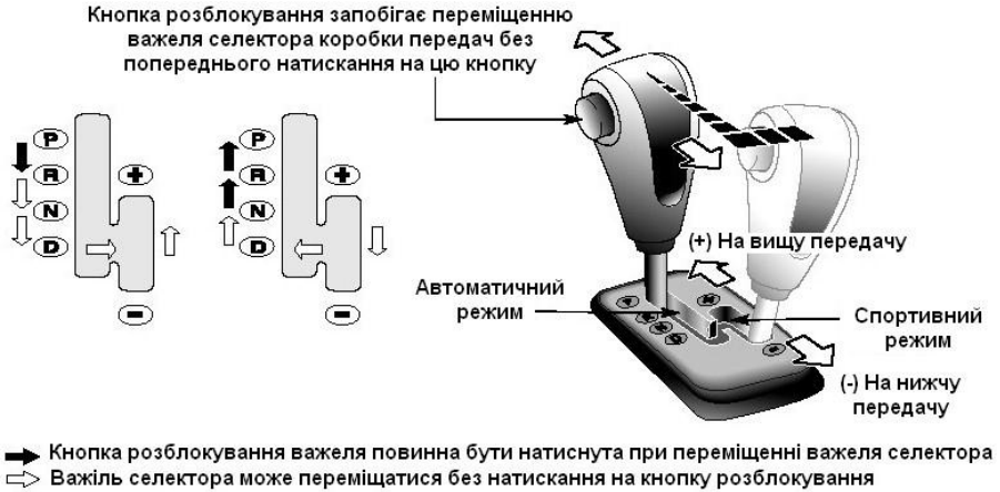
Рисунок 14.17 - Функція автоматичної коробки передач Tiptronic
