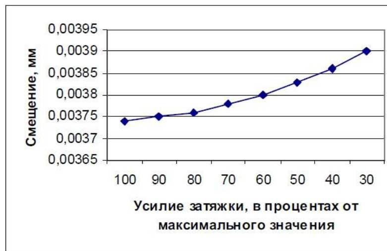
Рисунок 4.12 - Залежності максимального зміщення елементів круга від зусилля затягування гвинтів притискного фланця
