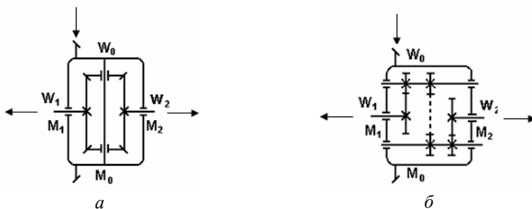
Рисунок 6.26 - Схеми симетричних диференціальних механізмів а - конічний, б - циліндричний
