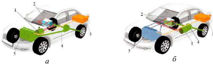
Рисунок 3.2 – Принципові схеми гібридних установок автомобіля Toyota
