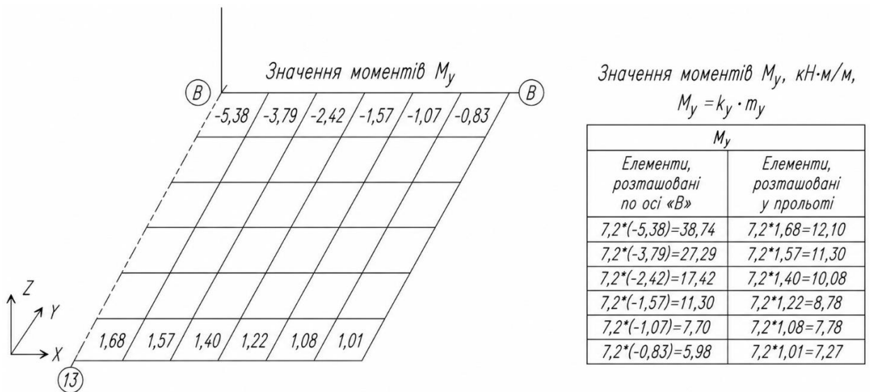
Рисунок 2.5 – Розрахунок моментів M_y в плиті
