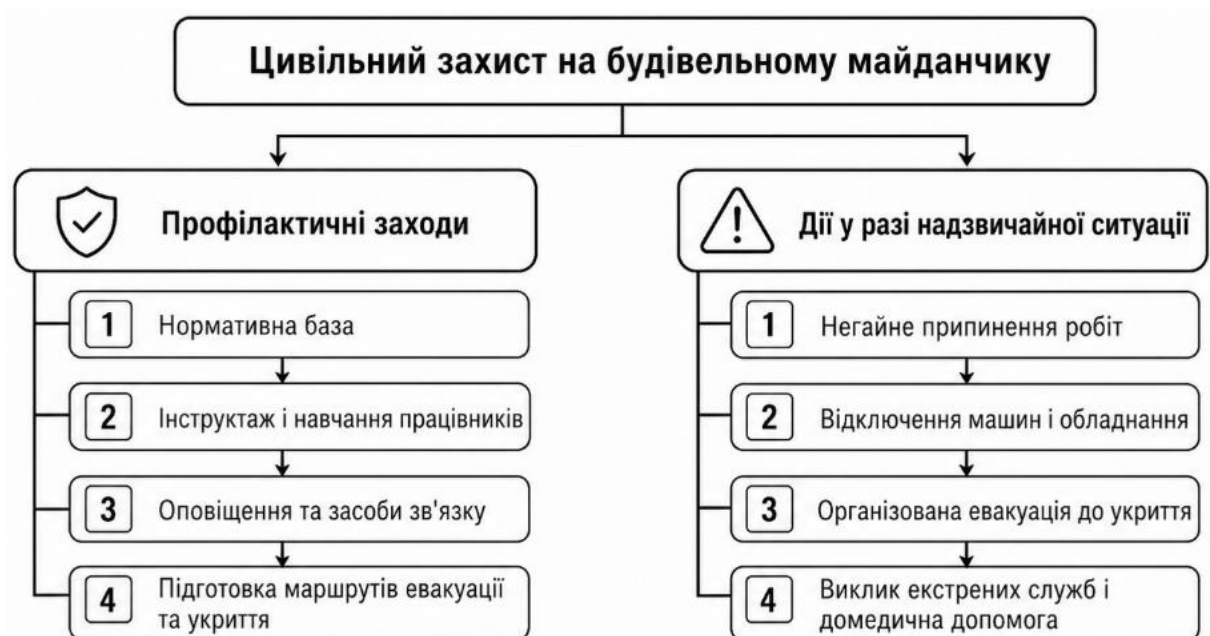
Рисунок 5.2 – Принципи цивільного захисту на будівельному майданчику
