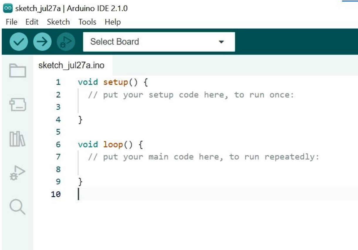
Рисунок 4.7 – Arduino IDE середовище для редагування та завантаження програмного коду в контролер Arduino
