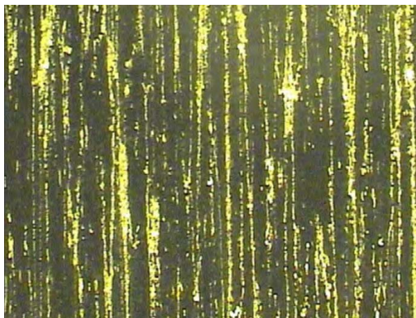
Рисунок 1.3 - Карбідна неоднорідність (6 бал) сталі P6M5Ф 3-Ш, \times 100
