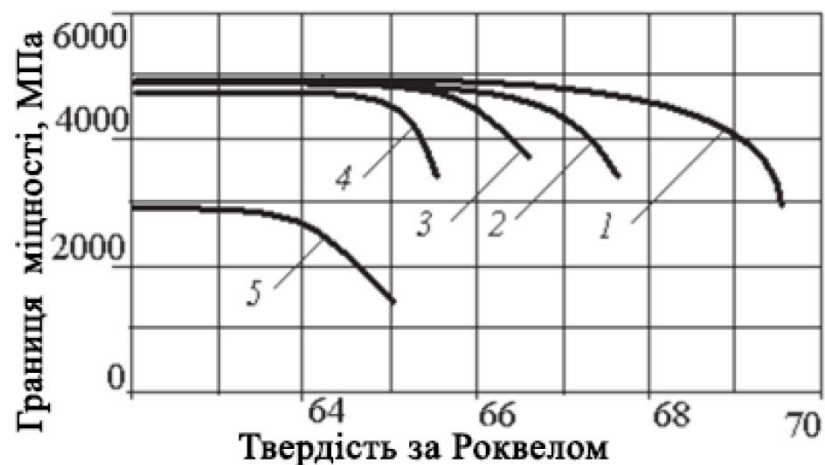
Рисунок 1.10 - Властивості різних швидкорізальних сталей: 1 – REX121; 2 – S380; 3 – REX76; 4 – порошкова ШРС; 5 – звичайна ШРС
