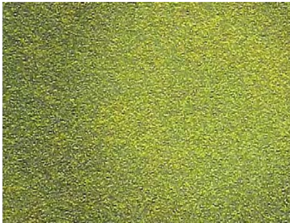
Рисунок 1.2 - Карбідна неоднорідність (1 бал) сталі S390PM, \times 100
