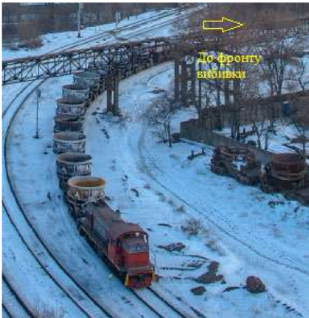
Рисунок 1.5 – Подавання составу на фронт вибивки ковшами уперед зі станції Шлакова
