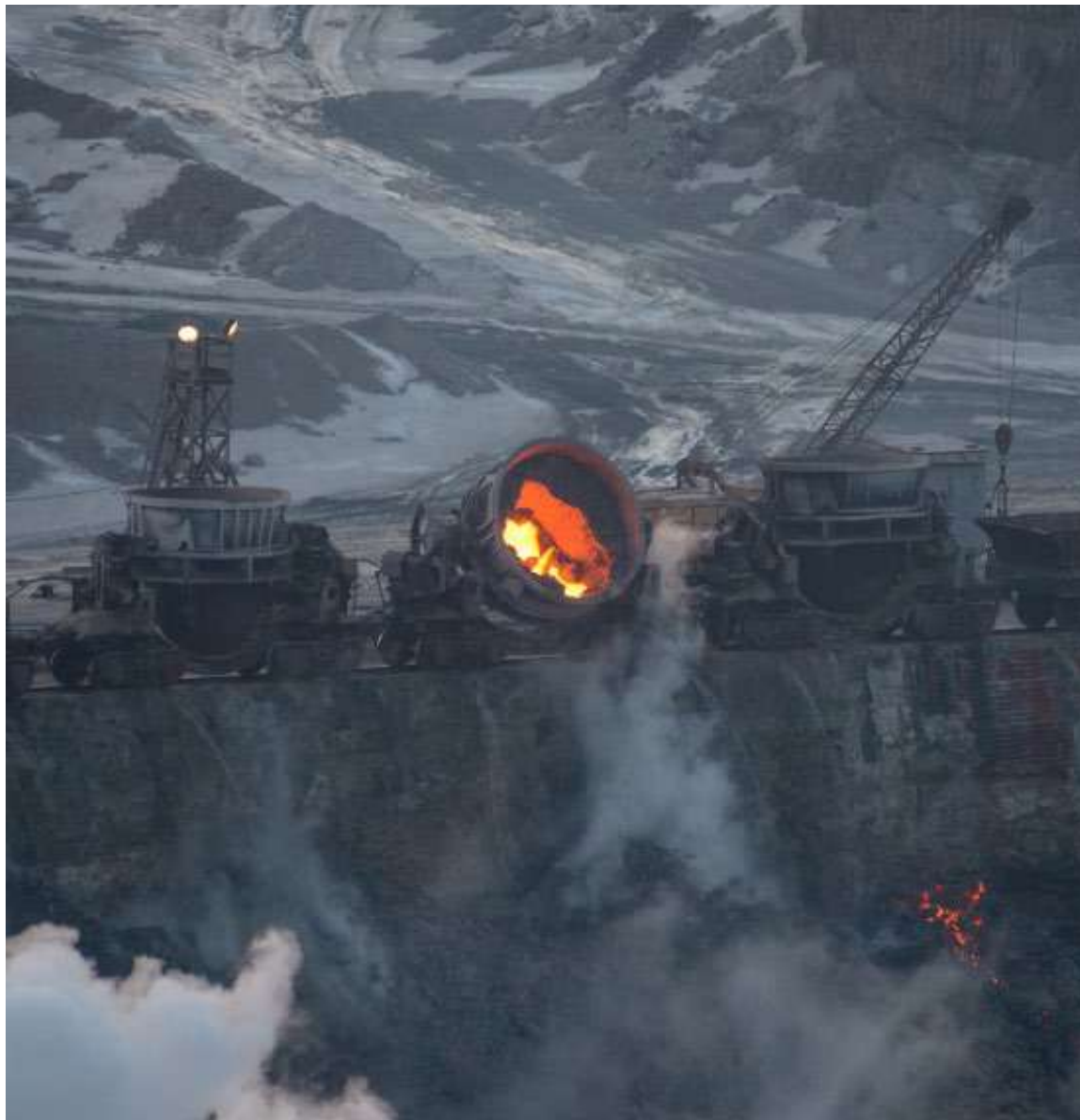
Рисунок 1.8 – Процес кантування шлаковозів
