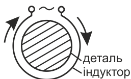
Рисунок 2.57 – Схема гартування з нагріванням СВЧ
