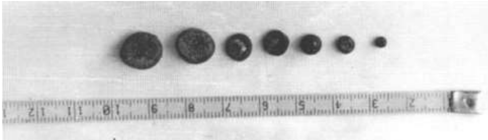
Рисунок 3.8 – Краплі металу, що формуються під час плавлення комбінованого електрода Fe-Cu
