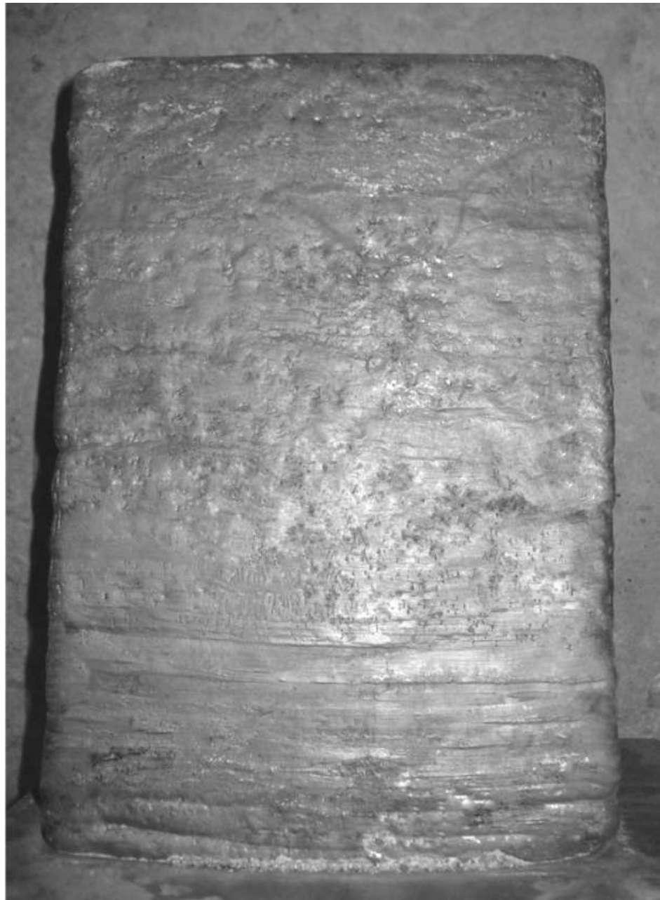
Рисунок 3.13 – Стан поверхні злитка при переплаві рознесеного електрода з геометричним коефіцієнтом заповнення 0,37.
