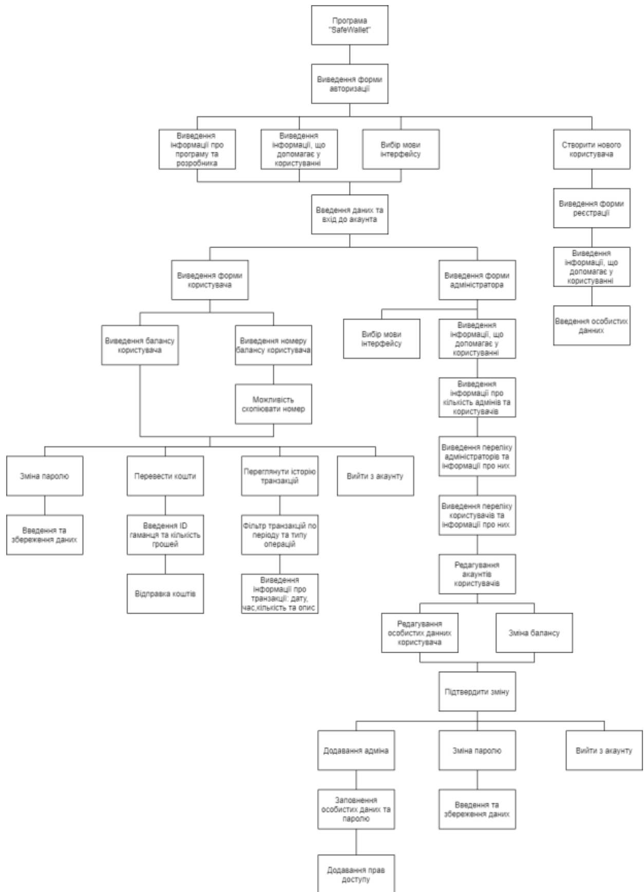
Рисунок 3.3 – Схема процесу функціонування програмного забезпечення інформаційної системи електронного гаманця при роботі з користувачем
