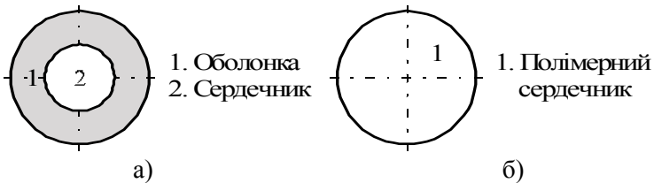
а) серцевина з захисною оболонкою, б) світловод без додаткових захисних прошарків
