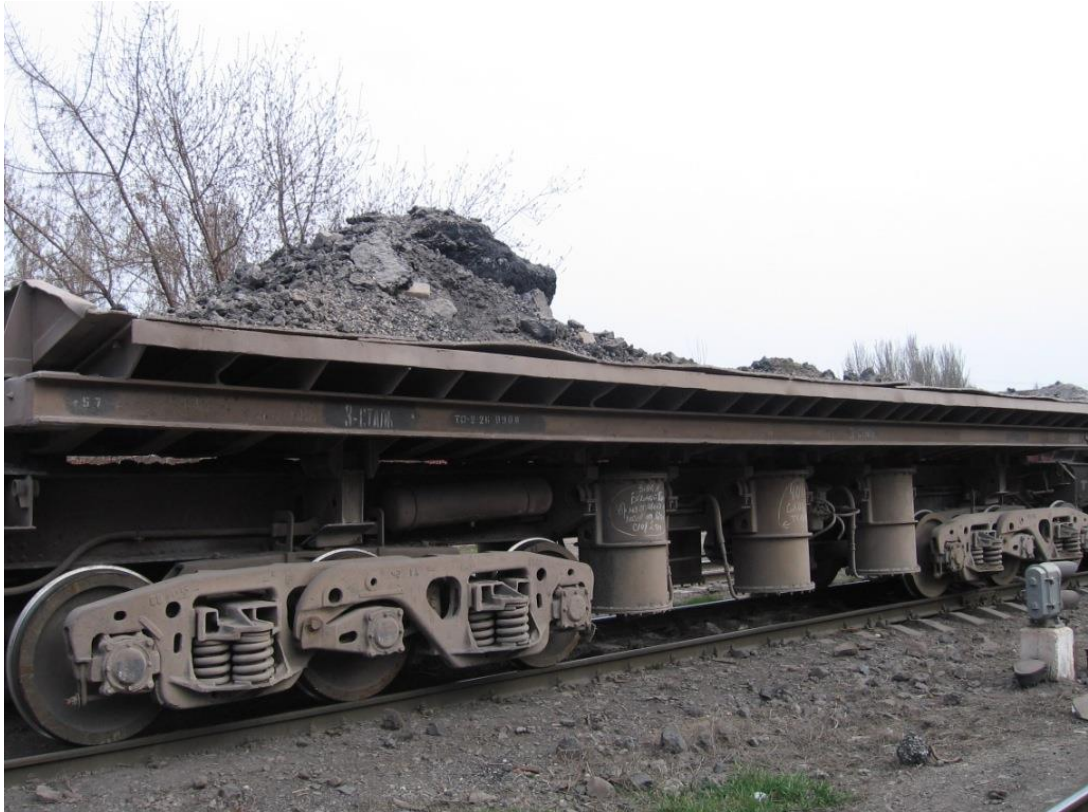
Рисунок 1.4 – Навантаження безбортного думпкару шлаком
