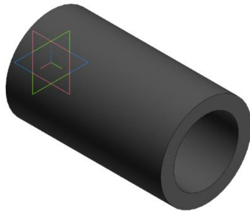
Рисунок 1.2 – Тривимірна модель заготовки, що отримана з трубного прокату круглого перерізу
