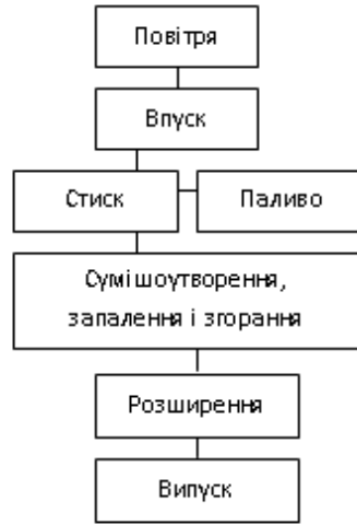
а - із зовнішнім сумішоутворенням, б - із внутрішнім сумішоутворенням Рисунок 1.7 - Схеми робочого циклу двигунів
