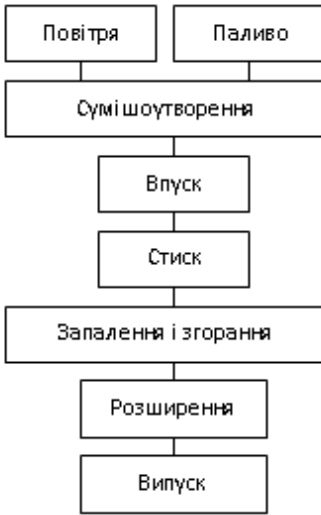
а - із зовнішнім сумішоутворенням, б - із внутрішнім сумішоутворенням Рисунок 1.7 - Схеми робочого циклу двигунів
