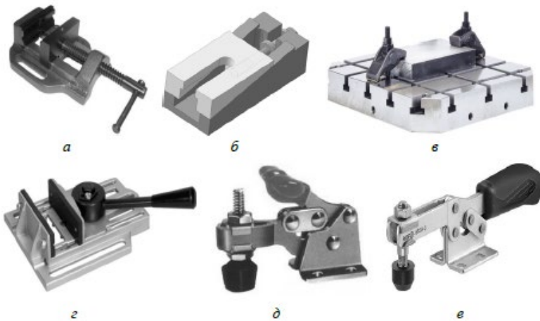
Рисунок 7.1 – Приклади використання гвинтових (а), клинових (б), важільних (в), ексцентрикових (г), шарнірно-важільних (д,е) механізмів
