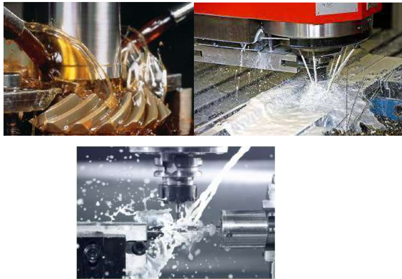
Рисунок 3.1 – Приклад використання ЗОТС на верстатах
