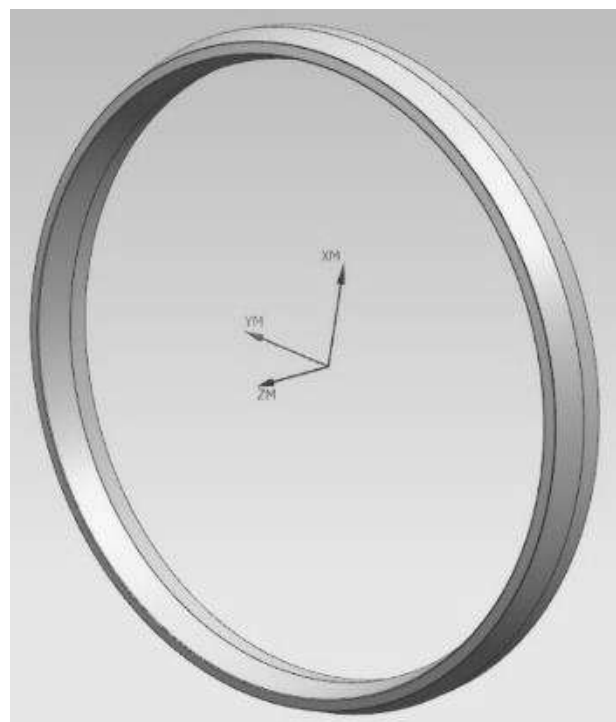
Рисунок 1.16 - 3D-модель заготовки «Кільце опорне зовнішнє»
