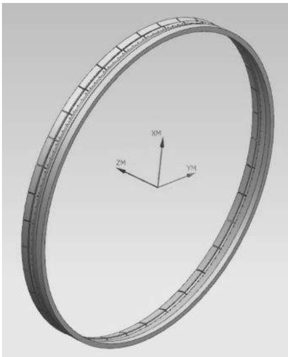
Рисунок 1.15 - 3D-модель деталі «Кільце опорне зовнішнє»
