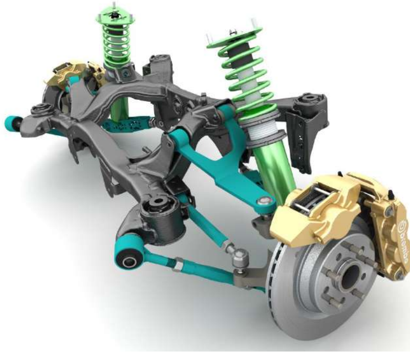
Рисунок 2.7 – Підвіска автомобіля із гнучкими важелями
