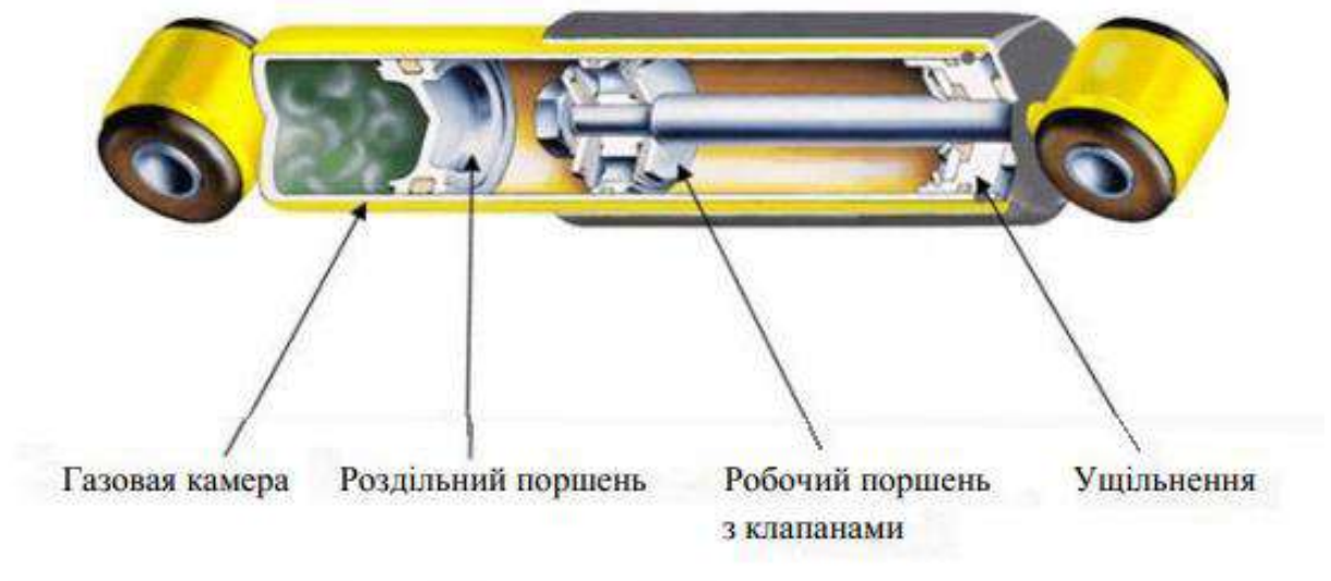
Рисунок 2.4 - Однотрубний амортизатор
