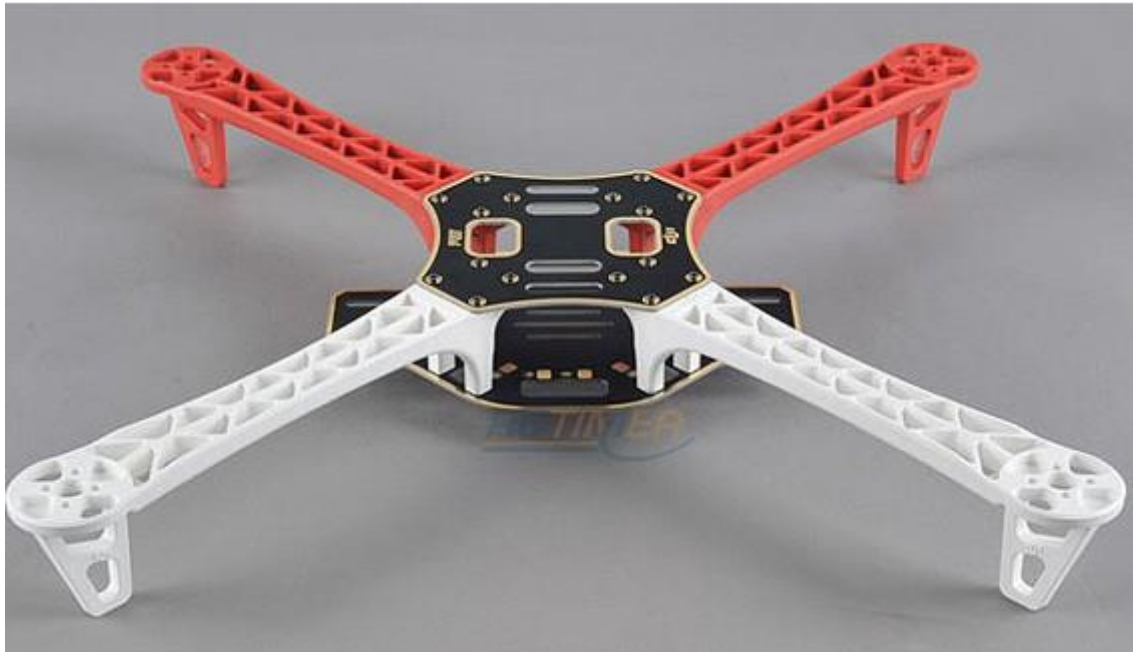
Рисунок 1.3 – Рама квадрокоптера X-типу
