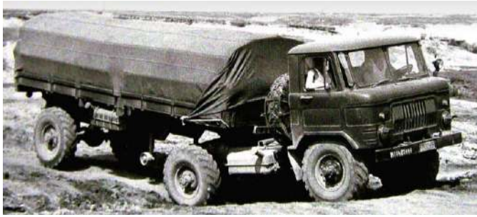
Рисунок 7.3 – Дослідний спеціальний тягач ГАЗ-66К: а – з активним напівприцепом-шасі; б – з одновісним напівприцепом з механічним приводом коліс
