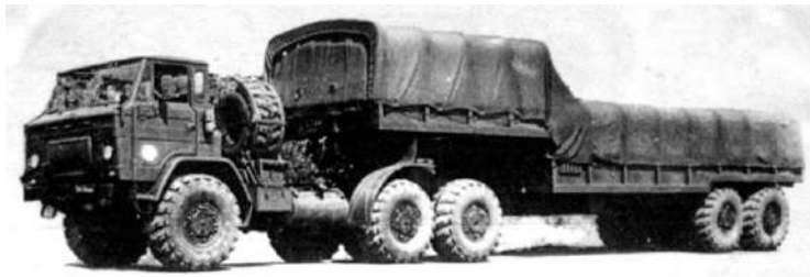
Рисунок 7.9 – Дослідний тягач КрАЗ-Е259 з активним бортовим напівпричепом Е834
