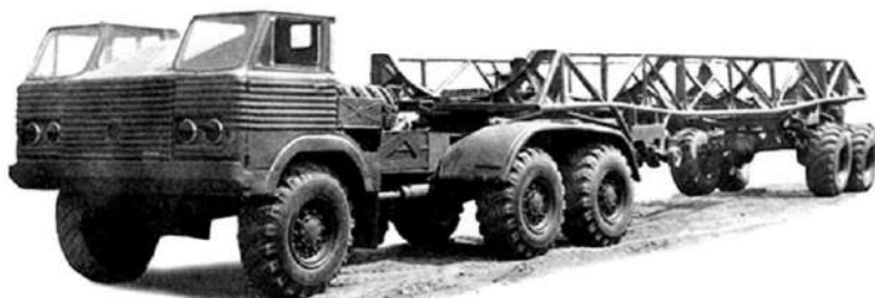
Рисунок 7.12 – Проект застосування напівпричепи 40П із сідельним тягачем на шасі вантажівки І-21-15
