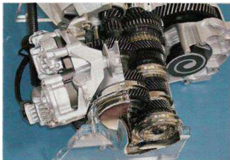
Рисунок 3.13 – Роботизована коробка Durashift EST (трансмісія «Форда»)
