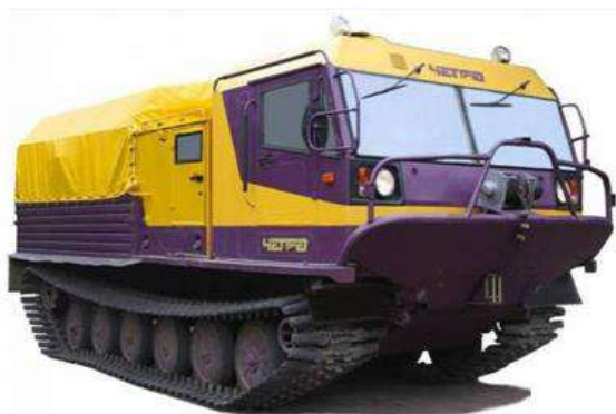
Рисунок 8.31 – Загальний вид ТМ-140: експлуатаційна маса – 11200 кг; середній тиск на ґрунт – 0,22 кгс/см 2 ; максимальна швидкість руху по суші – 45 км/год, на плаву – 4 км/год; місткість кабіни – 7 чол.; довжина – 7800 мм, ширина – 3100 мм, висота – 3105 мм; базовий двигун ЯМЗ-236Б2 – 184 кВт/250 к.с. з турбонаддувом; базова трансмісія – гідромеханічна 6-ступінчаста з гідравлічним перемикуванням передач
