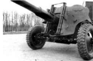
Рисунок 7.4 – Оригінальний автопоїзд у складі вантажівки ГАЗ-63А ( а ) та ( б ) активної гармати. Механічний привід ( б ) ведучих коліс активної 85-мм гармати СД-44
