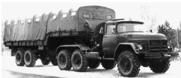
Рисунок 7.6 – Спеціальний сідельний тягач ЗІЛ-157КВ-1 із відбором потужності на напівпричіп (а). Прототип активного автопоїзда ЗІЛ-137(б) з гідростатичним приводом
