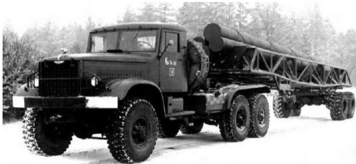
Рисунок 7.10 – Дослідний автопоїзд КТ-214-40П із трубчастими імітаторами довгомірних ракет
