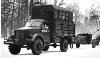
Рисунок 7.4 – Оригінальний автопоїзд у складі вантажівки ГАЗ-63А ( а ) та ( б ) активної гармати. Механічний привід ( б ) ведучих коліс активної 85-мм гармати СД-44
