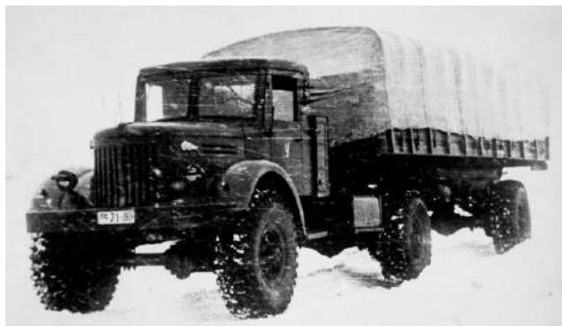
Рисунок 7.7 – Сідельний тягач МАЗ-502В з одноосьовим активним напівприцепом
