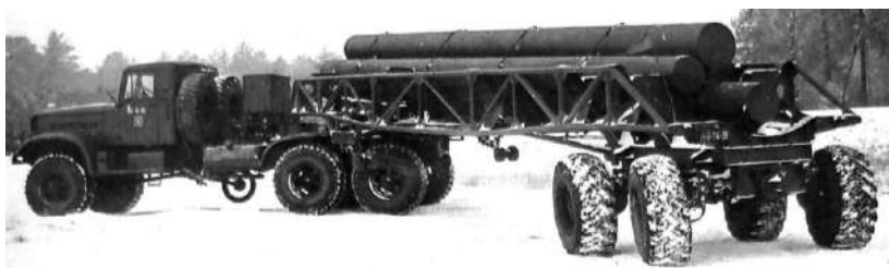
Рисунок 7.11 – Напівпричіп з усіма керованими колесами із сідельним тягачем на шасі ЯАЗ-214
