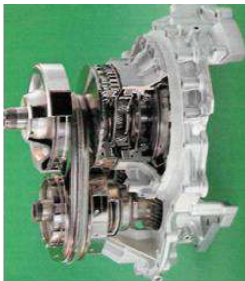
Рисунок 3.5 – Вариатор Durashift CVT (сумісна розробка «Форд» та фірми ZF)
