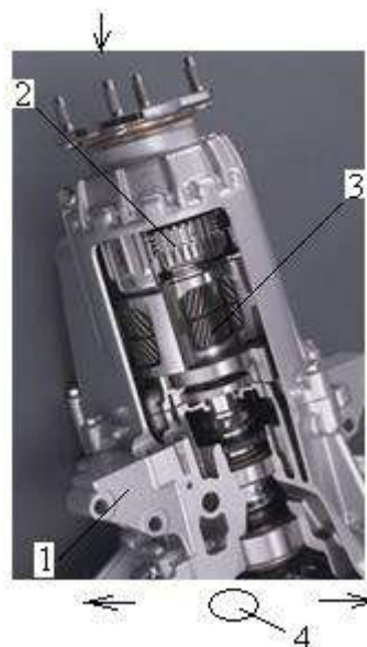
Рисунок А.3 – Підвищуюча передача трансмісії SH-AWD: 1 – корпус; 2 – гідропідтискаєна фрикційна муфта; 3 – сателіти планетарного ряду; 4 – головна передача; \rightarrow – напрямок руху потоку потужності
