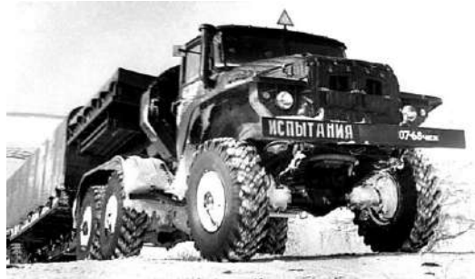
Рисунок 7.8 – Експериментальний тягач Урал-380 ( а ) з відкритим активним напівпричепом-шасі. Випробування тягача Урал-380 ( б ) із закритим активним напівпричепом Урал-862
