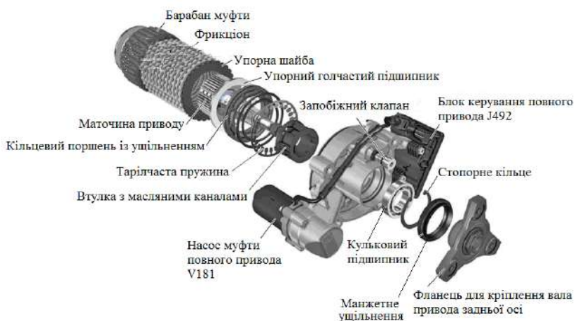
Рисунок 1.27 – Елементи конструкції Haldex V покоління
