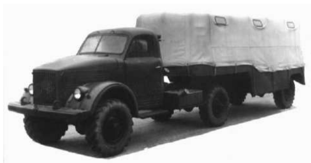
Рисунок 7.1 – Сідловий тягач ГАЗ-63Д з активним чотиритонним напівпричепом ГАЗ-745
