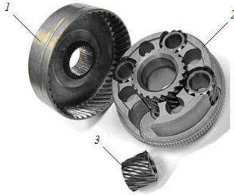
Рисунок 6.29 – Диференціал Torsen T3: 1 – корпус епіциклічної шестерні; 2 – водило; 3 – сателіт
