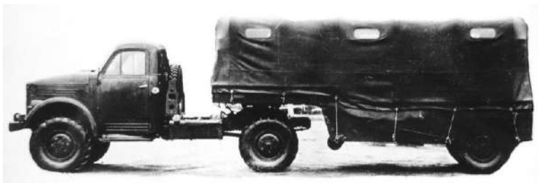
Рисунок 7.2 – Активний автопоїзд із тягачем ГАЗ-63Д та вантажопасажирським напівприцепом
